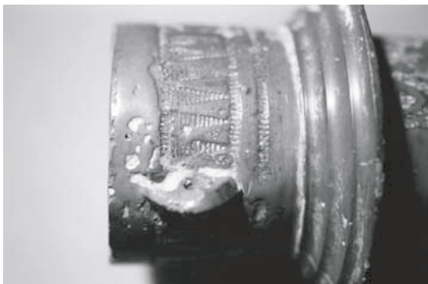
写真16 . 2号竿頭鈴下部の鈕と周辺の文様で写真15と同じ位置。鈕の付け根を中心に激しい凝固時のガスの窪みがある。最上部の横帯文様とガクの距離が長い。
