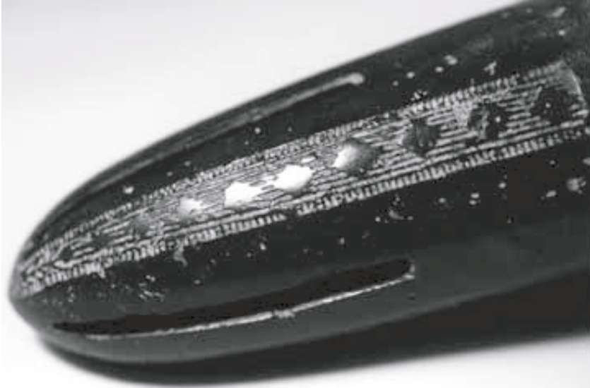
写真5 . 1号竿頭鈴上部の文様で写真6と同じ位置。右から3、4、5番目の菱形の上にある横方向の直線文様部分はシャープに鑄造されている。5、6番目の菱形周辺は親の范に線を彫るときに起きた砂崩れ。それを子の1号が写し取っている。
