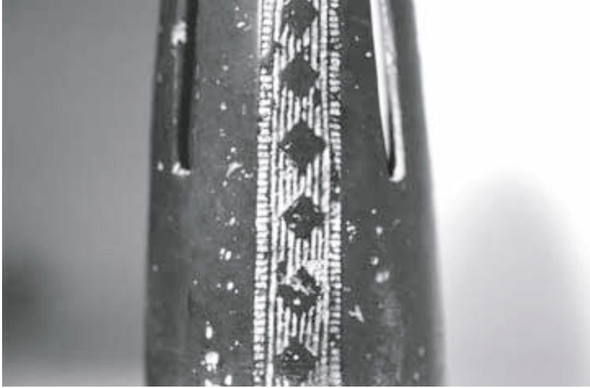
写真3 . 1号竿頭鈴上部の文様で写真4と同じ位置。下から3、4、5番目の菱形の右にある横方向の直線文様部分はシャープに鑄造されている。左下部分には鑄造時のガスによる窪みがみられる。
