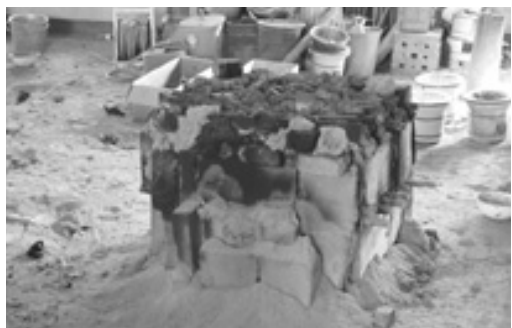
5時間かけて鑄型を焼き最後に土で窯をふさぐ
