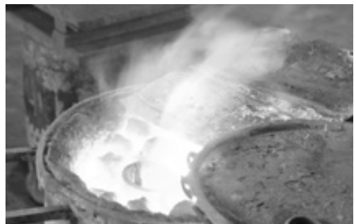
コークス溶解炉で青銅を溶かす
