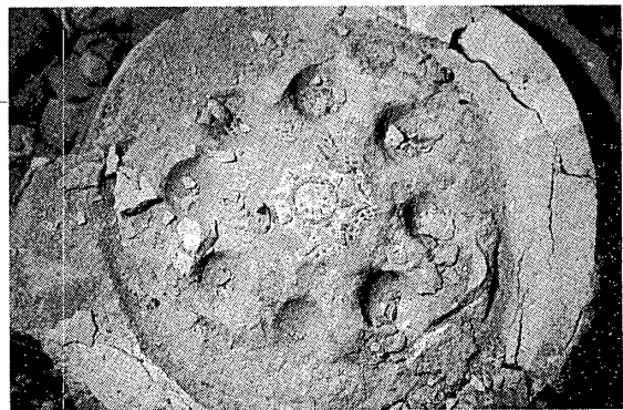
④⑩レンガで囲いすぎて焼成したため焼成が不十分になった鑄型中央には鑄型砂中の粘土の結晶水が残り、鑄造した高温の青銅と反応しガスが発生する。その結晶水のため鑄型面の文様が製品にきれいに写し取れない。そういった部分は製品と鑄型が簡単にはがれる。製品に鑄型砂が付着したところは、鑄型の文様を写し取っていることになる。
