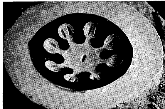
⑥それぞれの鈴部に2つの孔の形を描き、抜け勾配の形に穴を掘り込む。掘り込む穴は約4mmの深さ。後で、この穴に鈴の中子（ナカゴと読み、中型のこと）の突起部を差し込んで埴汁で接着して固定する。
