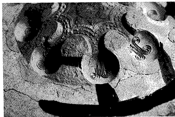
⑦鈴の上面にある双頭渦文は、木蠟を液化する時に鑄型砂が壊れた部分もある。またシャープに残った部分もある。木蠟の液化時に文様部の鑄型砂がシャープに残った部分は全体の7割程度である。
