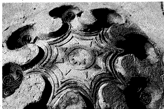
⑨木蠟がしみ込んだ後、八珠鈴表側の鑄型を開ける。文様中央の小さい三角形はすでにちぎれ取れている。木蠟が液化する時の膨張があると思われ、炭火よりも更にゆっくりと加熱する必要があるようだ。この結果から、十分に自然乾燥させ、晴天の太陽熱でゆっくり加熱する方法がいいのではないかと考えている。
