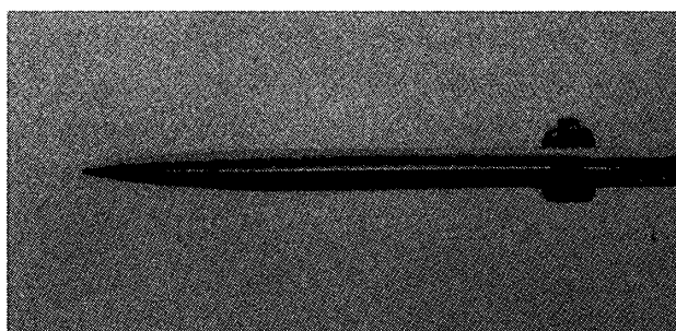
① 閉じられた状態の刃の隙間 (中央で1.6mm)
