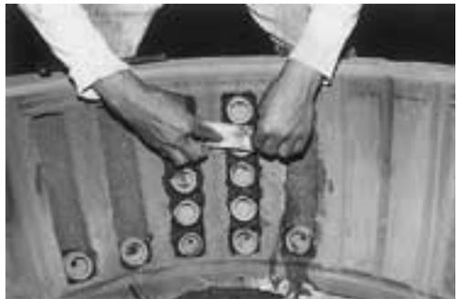
写真19. 富山県高岡市(有金森鑄造で梵鐘の乳(パーツ型)を外型に埋けこんでいるところ。故宮の罐の鈕にも埋け込みの痕跡が見られる
