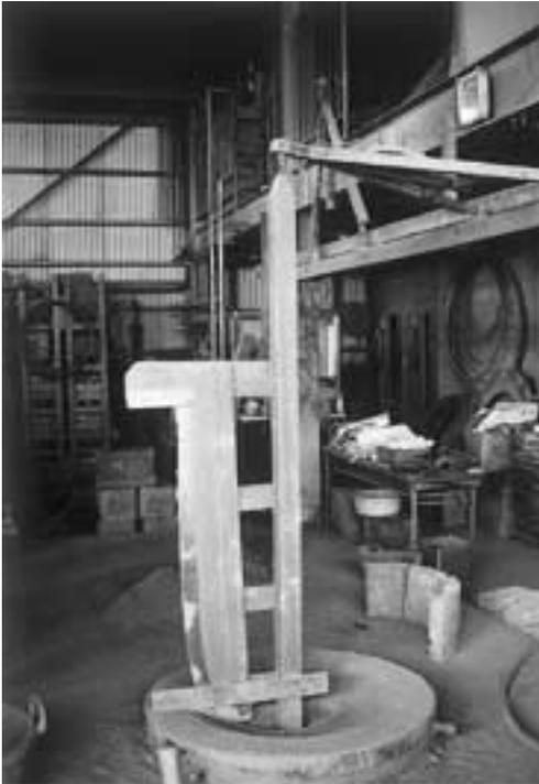
写真9. 富山高岡市、(有金森)鋳造の梵鐘外型用の挽き型ゲージを取り付けたところ。故宮の罐も同様の挽き型ゲージを回転させて外型を作ったものがある
