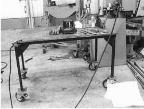
写真17 金属実習室の組み立て溶接作業台
