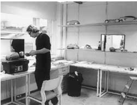
写真14 IDクレイによる模型制作室。室内に粘土を軟化させる電気炉が設置されている
