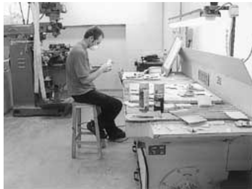
写真15 ウレタン等による模型制作室。切削による粉塵を吸引する作業台の上で作業
