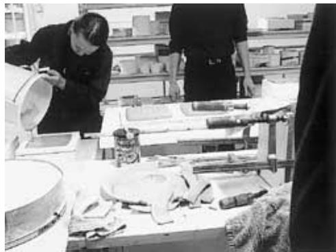
写真16 陶芸実習室。量産するため石膏型に粘土を流し込み制作している
