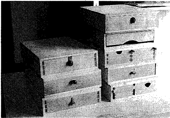
図6-1 引き出しの構造見本
