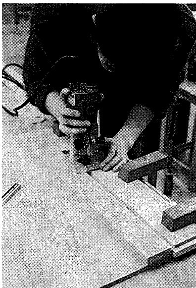
図7-2 ハンドルーターで角を削るためのジグとそれを使った作業風景
