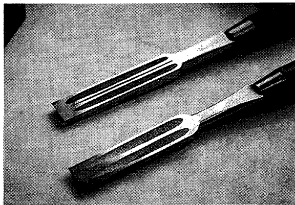
図17) 箱留め定規に対応した腰型鑿
