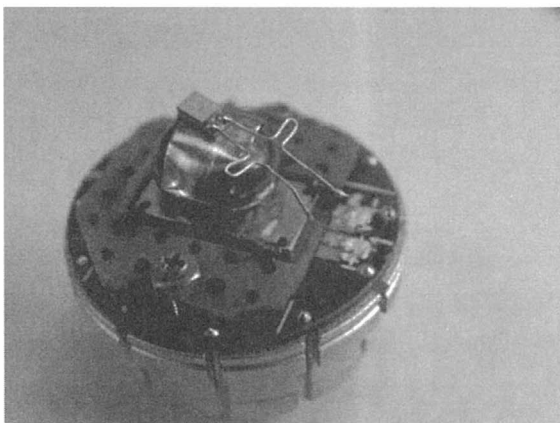
図1. PPMSのPuckに装着した極低温生成のためのデバイス。
