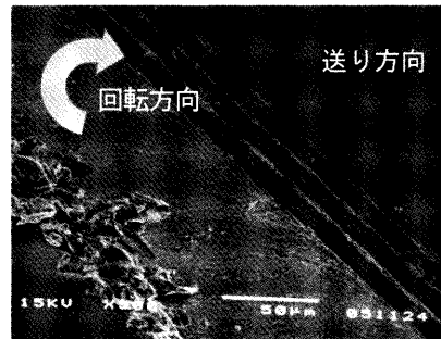
図7 階段形状加工痕のSEM観察像
