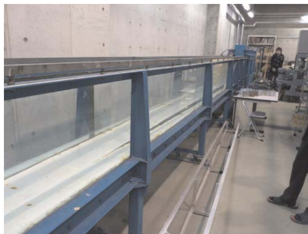
Fig. 2: 実験に用いる造波装置を有する断面水槽
