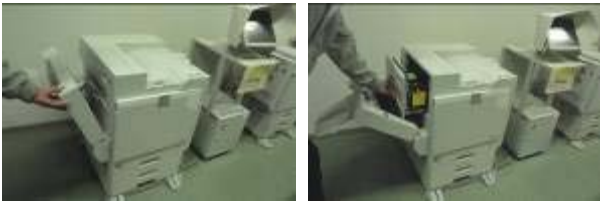
写真5 プリンタの両面・定着ユニットを開ける
