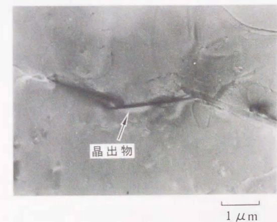
図6-10 As-cast材のTEM像
