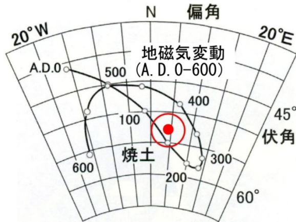
図 5-25. 焼土の磁化方向と紀元後 600 年間の地磁気変化との対比, 地磁気方向の変化は, 広岡(1977)より抜粋し加筆した.
