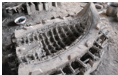
図11 筋金を粗土で覆い、焼いた様子。素灰を貼り、中に炭火を入れ鉄板で蓋をして中子を乾燥させ、強度を得る。
