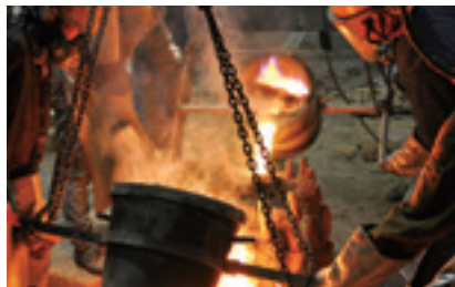
図32 鑄造中の様子。湯を定置炉から柄を付けた取瓶 とりべ に移し、クレーンで吊り上げて同時に二箇所から流す。
