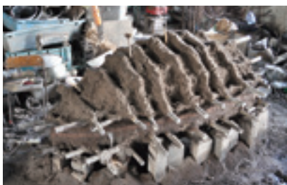
図2 閉じている状態の外型。大きな鋳型の場合変形を防ぐため、外に出ている筋金の下に煉瓦を置き鋳型を安定させる。
