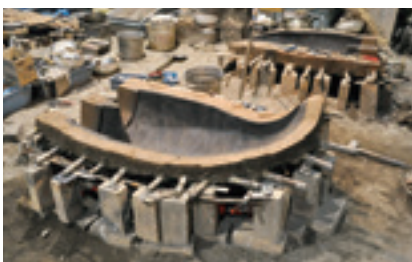
図4 原型を抜きとり、開いている状態の外型。手前が被せ型、奥が据え型。型の強度を増すため型の下に炭を置き、乾燥する。
