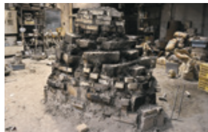
図30 色見に色が入り、焼竈を塞ぐ。隙間を土で埋め、保温する。
