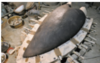
図20 中子を据え型に収め筭を埋める。中子表面にはハケ跡、凹凸がある。中子表面の痕跡が作品の内側の表面として残る。
