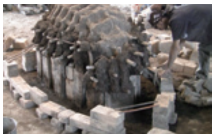
図25 鑄型下面の囲いと、焼竈下部。囲いの煉瓦の半分は倒すことができる。
