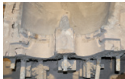
図24 湯道の様子。両方の外型に同様に掘り、中子の幅置面の外側を半周するような形の湯道。
