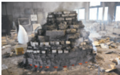
図28 焼成中の様子。薪を入れた直後は大量の煙が出る。下部の明かりが漏れている部分が通気口。砂をかけ少し絞った状態。
