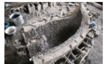
図6 中子砂は隙間ができないよう十分に叩き締める。浜砂を多く含む中子砂は、焼成時のひび割れを起こしにくい。
