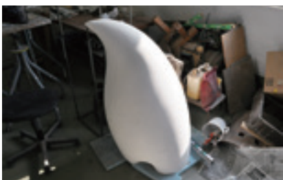
図1 本製作で使用した石膏原型。粘土原型から石膏取り。大きさ42×51×高100cm。
