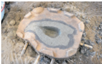
図23 別作品被せ型側の生合わせの中子。この技法では作れる作品の大きさに限界がある。
