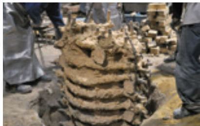
図31 湯を流すため鑄型を埋め、固定する。鑄型を移動させず、鑄造する場合もある。
