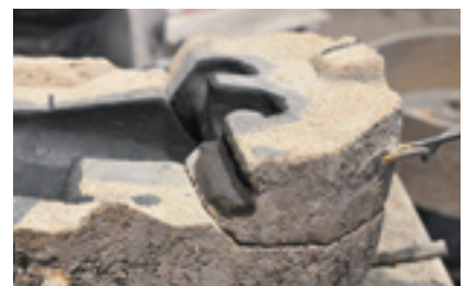
図3 別作品の鋳型の「寄せ型」。このように鋳型の外側に出る寄せ型は「大寄せ」。鋳型の中に収まる寄せ型は「小寄せ」。
