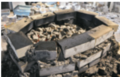
図29 煙道の様子。素灰の一部が赤くなってきている。煉瓦を積み、素灰を足していくため、煙道は徐々に高くなっていく。
