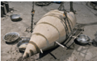
図17 胴巻き、鏝を入れて中子砂で埋める。胴巻きは針金で中子の胴を縛ること。鏝はコの字型の針金のこと。
