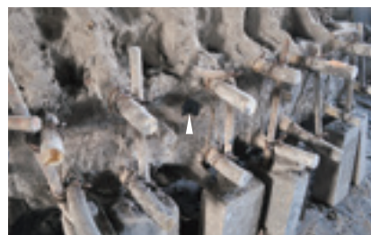
図21 外型側面の筋金を縛った様子。筭に衝撃を与えると中子が壊れることがある。型の合わせ目に色見がある(白矢印)。
