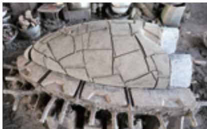
図13 中子を合わせた後、外型を開けた様子。中子と外型を固定していた針金は切って中子砂で埋める。
