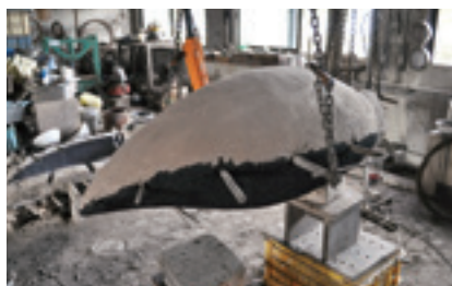
図19 黒味を塗っている途中の様子。塗りづらい下の面はクレーンで持ち上げた状態で塗る。
