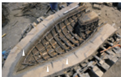
図8 被せ型の中子の筋金。緑の部分から中子どうしを縛る針金が数本飛び出しているのが見える(白矢印)。
