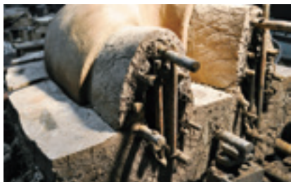
図16 中子の幅置の様子。中子の幅置の合わせ目は、内側から玉土を詰めて隙間を埋めた後、筋金を縛る。
