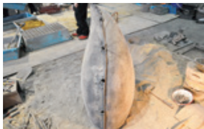
図34 筭を用いた込型鑄造では、鑄型の合わせ目の鑄バリに沿って筭の穴ができる。この鑄バリに沿って鑄引けができやすい。
