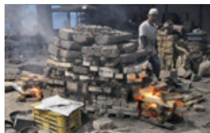
図27 完成した焼竈。頂上の素灰を積んである部分が煙道。焚口の前で薪に火をつけている。
