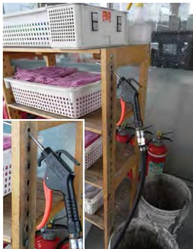
写真1,2 エアーガンのノズルが差し込まれている様子
