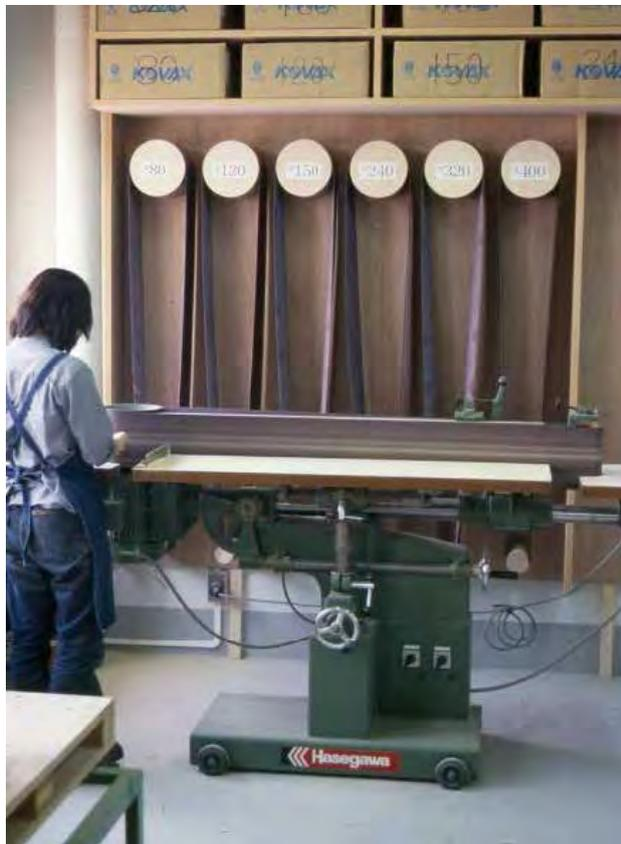
写真 12 新たに設計制作したベルトの収納棚
