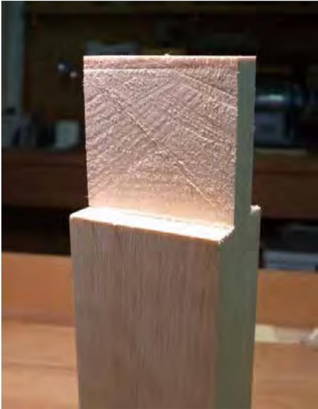
写真 10 ホゾの切削面に残した鋸跡
