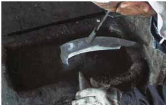
図 10 刀身の温度観察（冷却水から引き上げ時） t = 8.2 \text{ s} 刀身先の部分が冷却され、トンビ部分は約 120^{\circ}\text{C} （補正温度）になった。刀身裏側に現れる酸化色（テンパカラー）の移動の観察によって熱の伝導を把握する。
