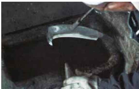
図 12 再投入後の温度観察 t = 12.6 \text{ s} 温度の高い部分は刀身ミネ部中央のみの状態になり、平均温度が 380^{\circ}\text{C} （緑から橙色）になる。刃金中央部分は平均温度： 110^{\circ}\text{C} 、刃先の温度： 96^{\circ}\text{C} （補正温度）になる。大久保氏は酸化色の移動を見極める
