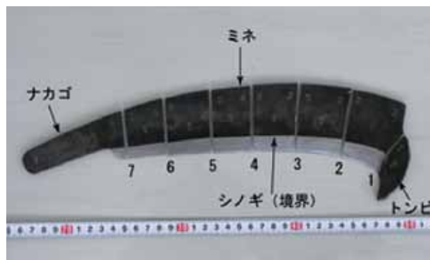
図1 分析のための7箇所切断した位置と泊鉈の名称
