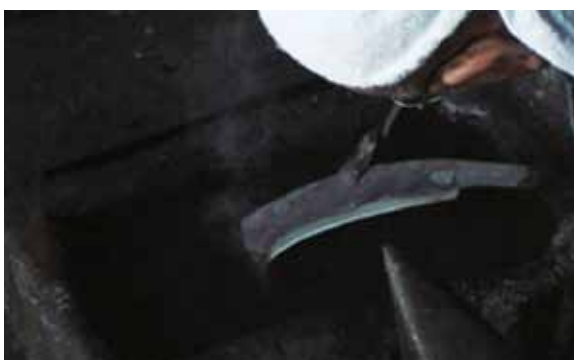
図7 トンビ部分の冷却 t = 5.0 \text{ s} 次にトンビ部分を水に投入して冷却を行い、トンビ付近の刃金の温度が先行して上がらないよう熱の伝導を止める。 ミネの赤い部分：480℃（補正温度）
