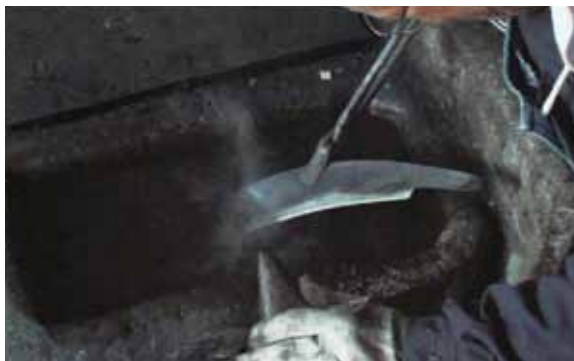
図 11 刀身先の部分を冷却水に再投入 t = 9.8 \text{ s} ミネの部分の熱がまだ刀身先に残っているため、冷却水に再投入した。
