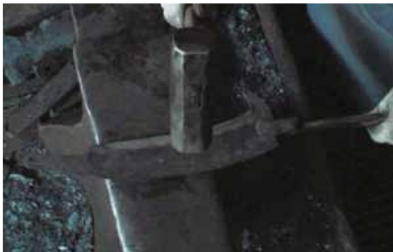
図 15 刀身の歪修正 t = 57.6 \text{ s}
