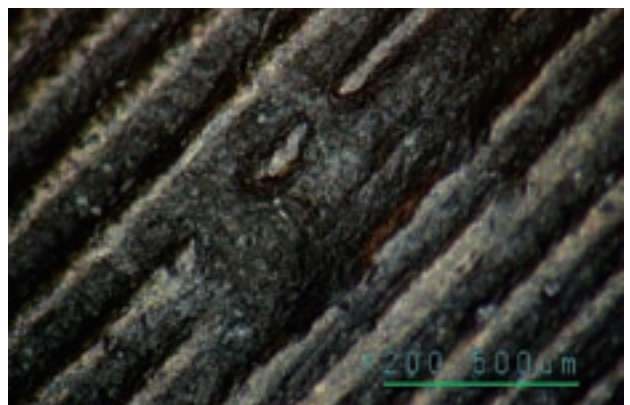
図12 武人頭髪部分鑄造欠陥
