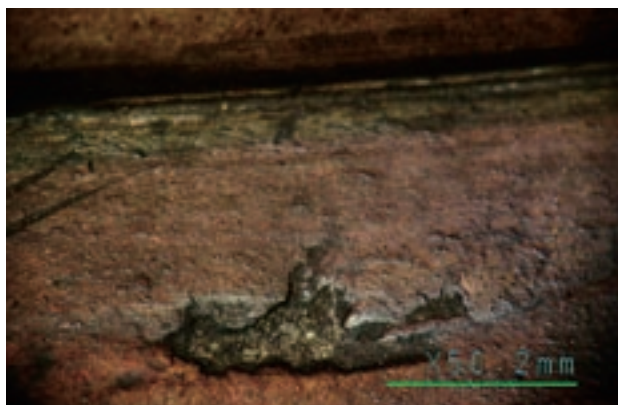
図 19 蓋本文様帯部分鑄造欠陥
