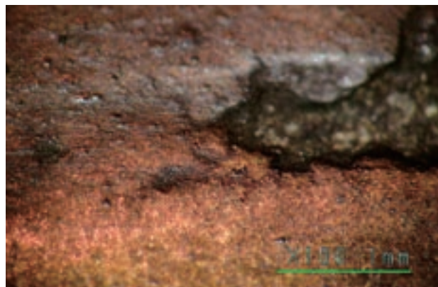
図 20 蓋本文様帯部分鑄造欠陥
