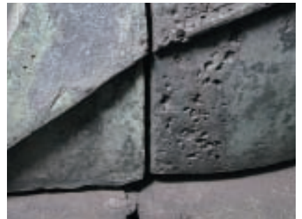
図13 九品寺大仏右側面 「中部」と「前部」の鑄接の上面には隙間が無いが右側面には3mmの隙間がある。これは図10の奥に見える光が差し込む隙間にあたる。
