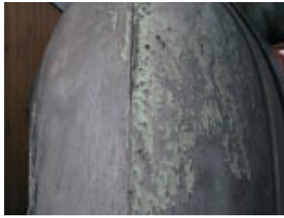
図6 九品寺大仏右体側面 左側面の分鑄痕跡と同じく直線的な接ぎ線。凝固ガスが気泡痕を作り肌が荒れている。この周辺に湯口があったのかも知れない。
