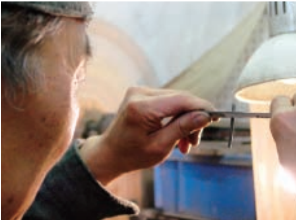
図7 擦り合わせ、アイの面の確認動作 相互のパーツを仮の目釘で組み合わせ、光にかざして穂の合わせり方の状態やアイの面の接触状態などを確認する。
