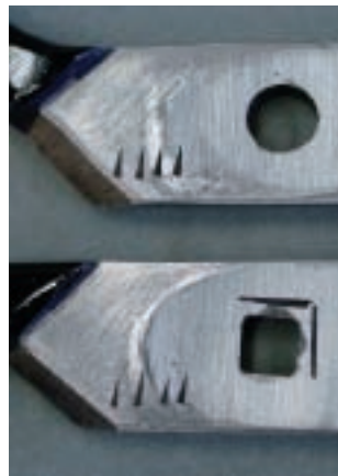
図7 擦り合わせ、アイの面の確認動作 相互のパーツを仮の目釘で組み合わせ、光にかざして穂の合わせり方の状態やアイの面の接触状態などを確認する。
