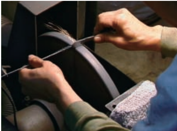
工程 43 研磨－5 # 220 の金剛砂バフによって座の側面を研磨する。
