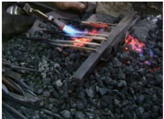
工程 30 「菱紋」の着色 菱紋部を加熱し刻印の溝に酸化色をつけると同時に、穂に予熱を与える。
