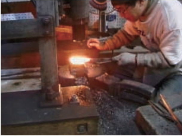
工程1 鍛造（地切り前）－1 穂と足の境に段をつけて足の鍛造準備を行う。
