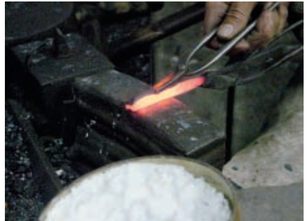
工程8 鍛接-3 ヤットコの長さを目安に高炭素鋼を設定する。(穂に対し平置き)
