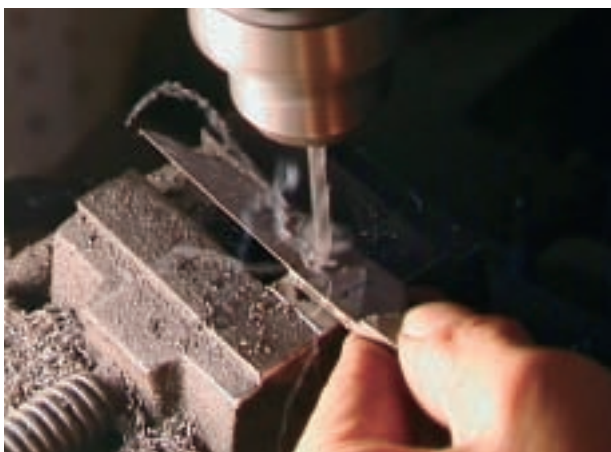
工程 23 目釘穴 卓上ボール盤によって目釘穴を開ける。
