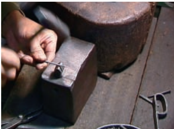
工程 47 目釘の切断 針金を刃鑿の上に設定し、適切な長さに切断して目釘を作る。
