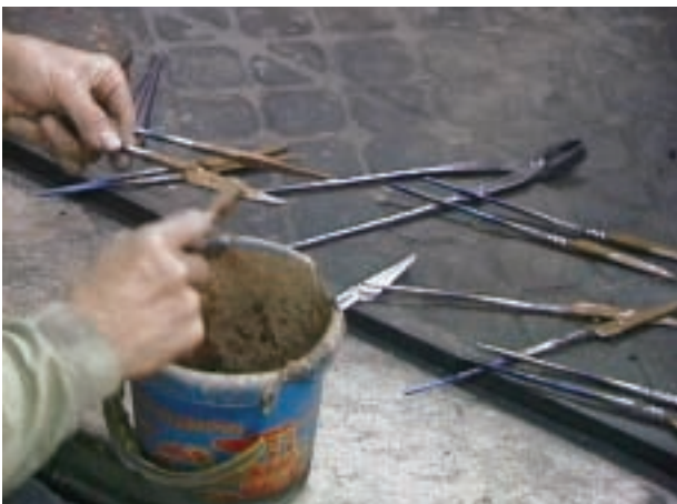
工程 29 焼入れー1 穂に焼刃土をブラシで塗布する。
