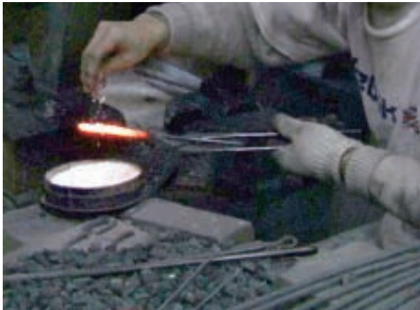
工程7 鍛接-2 極軟鋼の接合部に硼砂を散布する。
