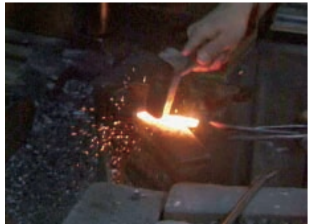
工程10 鍛接-5 極軟鋼と高炭素鋼を合わせて加熱し、金槌にて打って加圧接合する。
