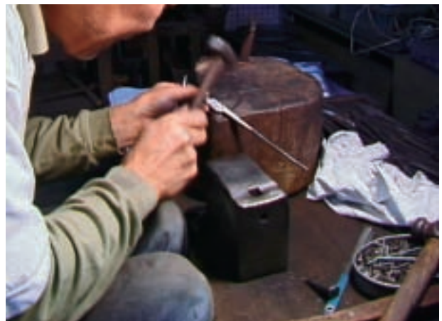
工程 18 均し－ 4 木台を使用して穂の曲がりを直すなど微調整を行う。
