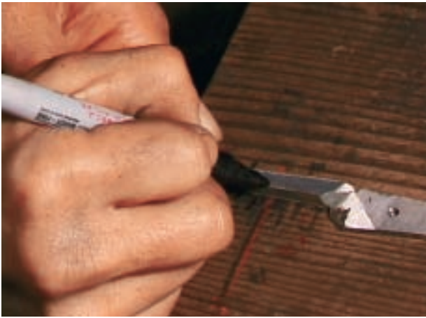
工程 25 「二の字」のケガキ アゴからの距離を測り、「二の字」の刻印を打つ位置を決定する。
