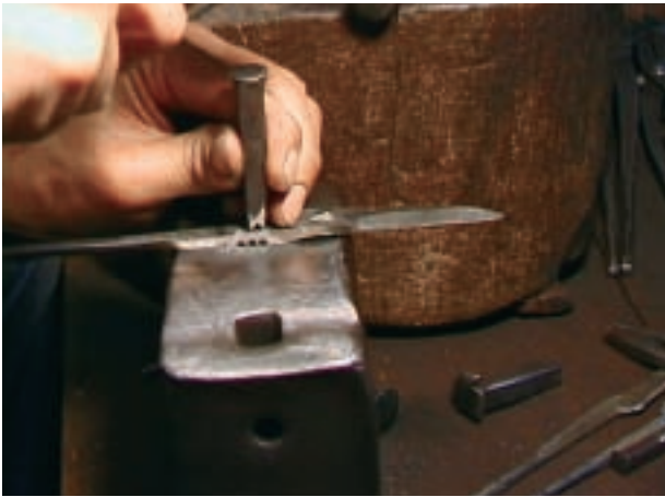
工程 27 「菱紋」の刻印 鑿によって「菱紋」の刻印を打つ。
