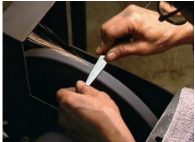
工程 40 研磨-2 # 220 の金剛砂バフによって刃シノギを研磨する。
