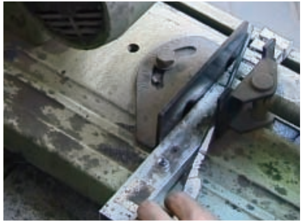
工程 28 足の長さ調整 目釘からの長さを測り、足の長さを切断機で切断する。
