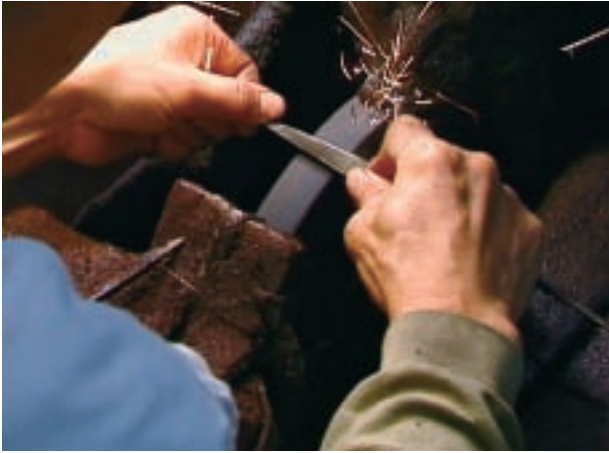
工程 37 本研ぎ-5 # 60 のグラインダーによってムネシノギを切削する（水研ぎ）。
