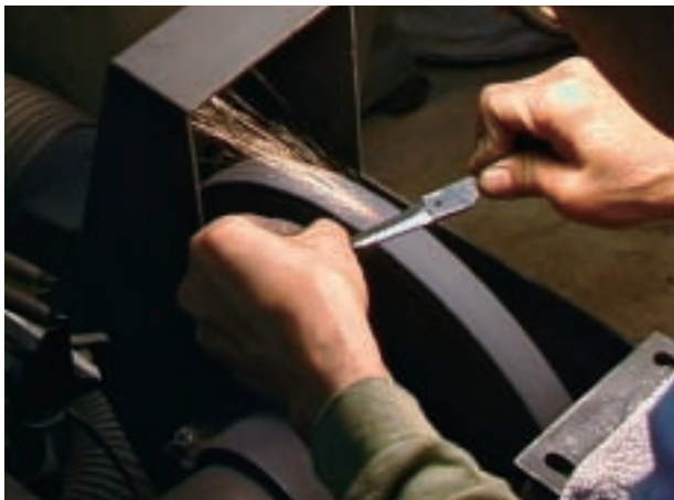
工程 45 研磨－7 # 220 の金剛砂バフによってウラを研磨する。
