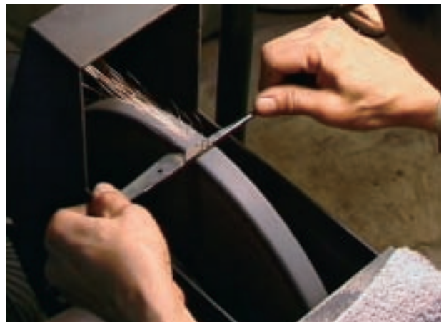
工程 42 研磨-4 # 220 の金剛砂バフによって菱紋部を研磨する。
