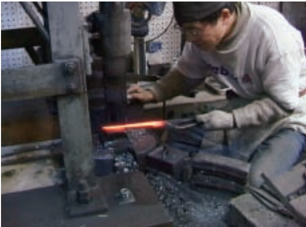
工程3 鍛造（地切り前）－3 足の打ち延べを行う。ハンマー部右三分の二の平らな鏡を使用して凹凸を均す。
