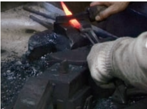
工程5 地切り－2 ベルトハンマーを使用し、手持ち鑿によって切断する。
