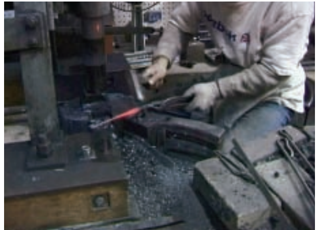
工程4 地切り－1 目安となる金床などの補助道具によって、一パーツ分の切断位置を決定する。
