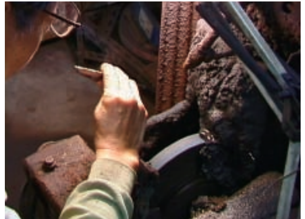
工程 20 アラトギの確認 穂を製作するときの基準が刃の直線やアイの面であり、その確認を常に行う。
