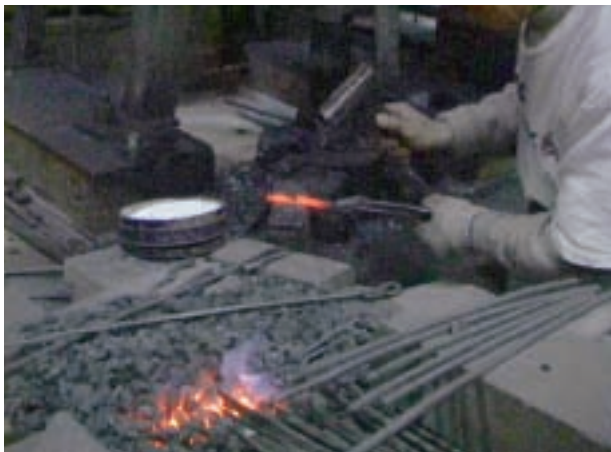
工程9 鍛接-4 高炭素鋼端の爪の部分を穂に打ち込んで、高炭素鋼がずれないように固定する。
