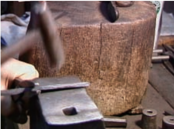
工程 15 均し－ 1 穂の曲がりを直すと同時に後シノギを打ち出し、冷間鍛造を行う。
