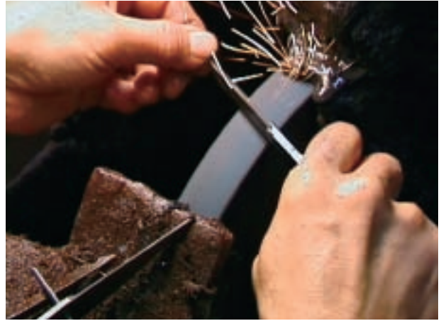
工程 38 本研ぎ-6 # 60 のグラインダーによってムネを切削する（水研ぎ）。
