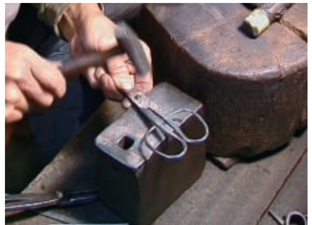
工程 48 目釘のカシメ 目釘の両端を打ってカシメを行い、二つのパーツを組み合わせて完成とする。
