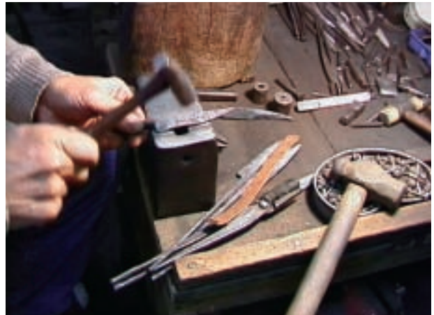
工程 16 均し－ 2 金床の溝を使用し、穂の曲がりを直すなど微調整を行う。
