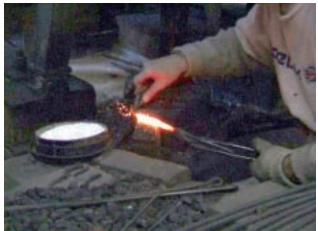
工程6 鍛接－1 極軟鋼の穂の部分を加熱し、不必要な酸化膜を剥ぎ取って鍛接の準備を行う。
