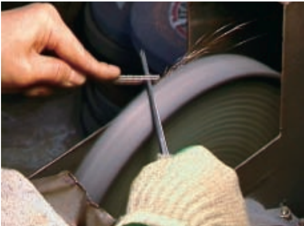
工程 39 研磨-1 # 220 の金剛砂バフによって足を研磨する。
