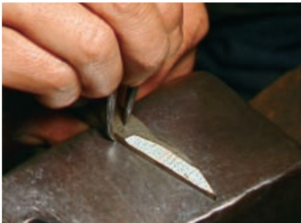
工程 21 目釘穴のケガキ 金属製のケガキパスを使用して目釘穴の位置を決定する。
