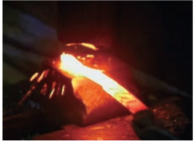
工程2 鍛造（地切り前）－2 足の打ち延べを行う。ベルトハンマーのハンマー部左三分の一のカラカミを使用する。
