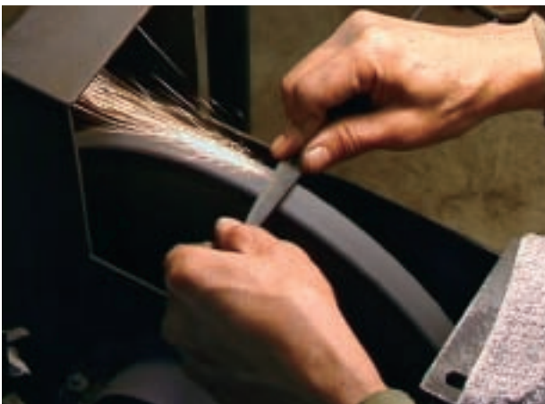
工程 41 研磨-3 # 220 のバフによってムネシノギを研磨する。
