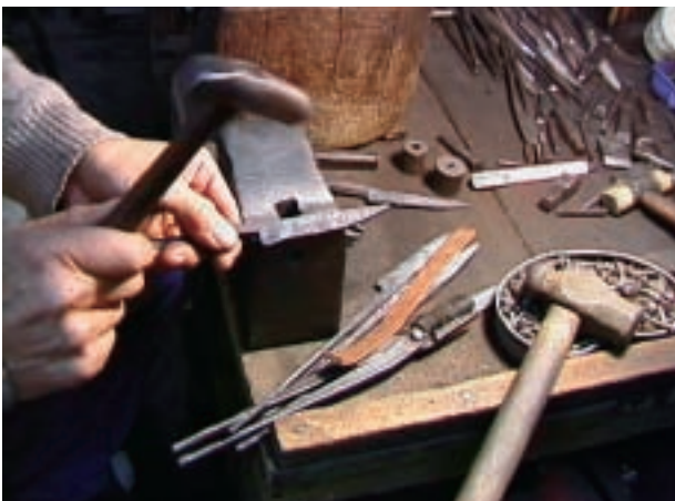
工程 17 均し－ 3 金床右端の窪みを使用して穂の曲がりを直すなど微調整を行う。
