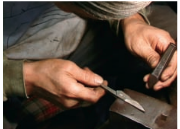
工程 22 商標の刻印 「宇印」の刻印を打つ。刻印された凹部に酸化色を付けるため、焼入れ前に行く。
