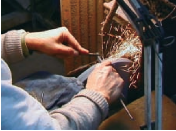
工程 13 刃部の切削 穂の鍛造によって刃先からはみ出した極軟鋼を切削する（水研ぎ）。
