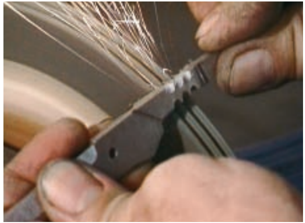
工程 26 菱紋エッジの切削 「菱紋」が刻印される位置のエッジを切削する。これは「菱紋」と同時に博多鋏の特色となる加飾である。
