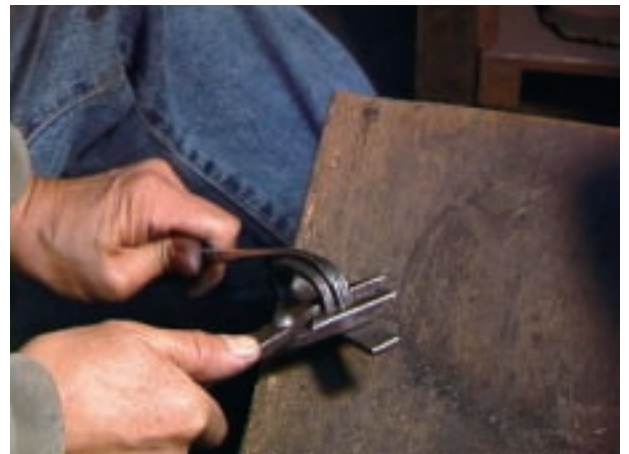
工程 46 足曲げー2 足曲げ型に沿わせて足を曲げる。足の先端をヤットコで握り止め、型に固定して順次曲げる。
