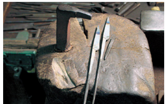
写真10 木台と当金 木台の上面に様々な凹面を作って、熱処理した後の穂の修正で使用する。また、当金によって足曲げの微調整を行う。
