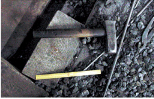
写真15 鍛造用ハンマー 鍛接・鍛造（穂の成形）に用いるハンマー。
