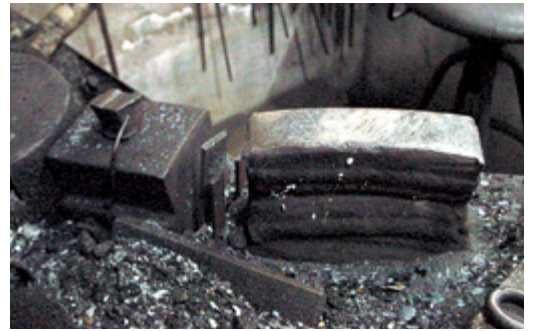
写真8 金床（鍛造用）と当金型 右側に鏡が凸状の鍛造用金床があり、左にシノギの位置を打ち込む当型が設置されている。
