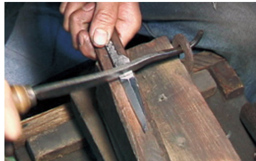
写真20 磨き台と磨き棒 木台についている金属製の輪に磨き棒の先端を掛けて支点とする。それを前後移動させて鋏の表面を磨く。この時「キド」といわれる粉末を用いたと言われる。（先代の道具）
