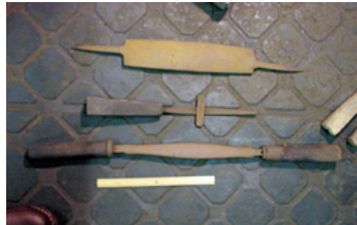
写真18 鋏（三種） 両端のハンドルを手で握り、中央の刃の部分で切削を行う。（先代の道具）
