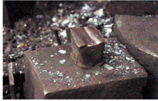
写真16 当型 座と刃シノギ、ムネシノギの境目を決定するための当型である。
