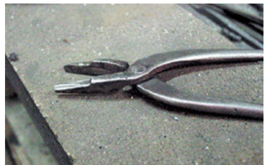
写真14 ヤットコ 先端部の側面に段を設け、アゴからの距離を測って高炭素鋼の位置を決定する工夫がされている。手前と奥の長さの違いは、鋏のサイズに対応している。
