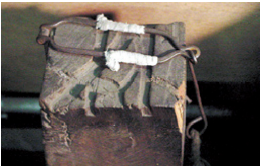
写真19 銘彫りの道具 木材の上面にある溝に鋏をはめ込み、布の巻いてある針金で押さえて銘を彫る。針金は足で引っ張って押さえ込む。（先代の道具）
