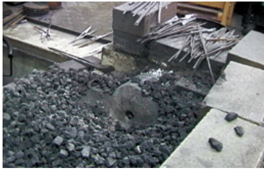
写真7 羽口 中央の穴から空気が送風される。周りは耐熱性の粘土で作られ、耐久性を増すために厚く作られている。
