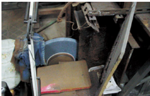
写真11 両頭グラインダー（切削用） #60の砥石が装着されている。切削は概ねこのグラインダーで行う。ホースから冷却用の水が供給される。
