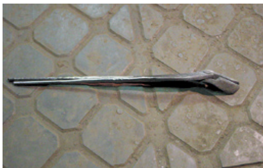
写真13 火箸 支点から先の部分が斜めに曲がっていて、長い棒でも加熱した加工部の近くを掴むことができる。
