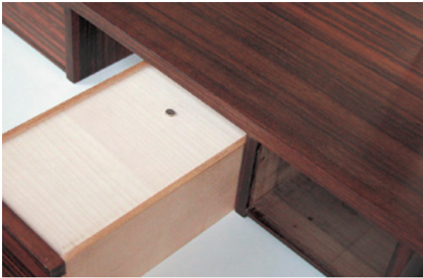
写真20 写真13の引き出し裏のマグネット。中央で止める工夫。
