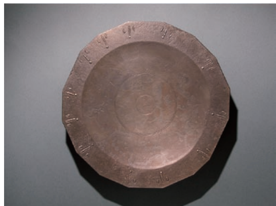
写真 19 <試作品 4> 表面処理後、銀白色変化
