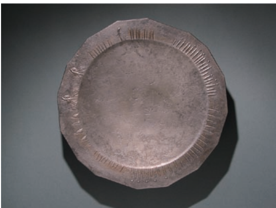
写真 18 <試作品 3> 表面処理後、銀白色変化
