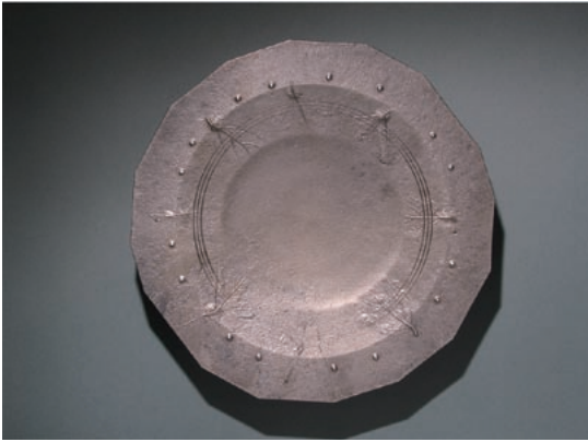
写真 16 <試作品 1> 表面処理後、銀白色に変化
