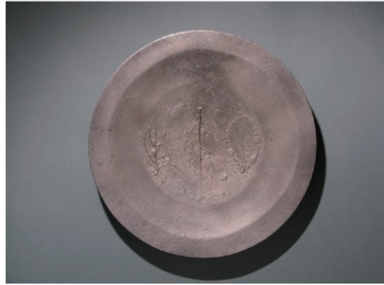
写真 17 <試作品 2> 表面処理後、銀白色変化
