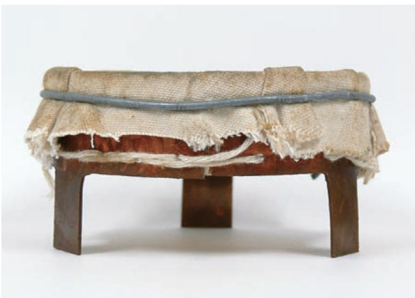
図3 溶解した地金を流し込む場所は、糸でしっかりと縫い合わせ、余分な布は外へ折り曲げ、ワイヤーで縛っている。中央の縫い目が布の底面の位置なので、銅製の枠がガスを溜め込まずに、ガスはすぐに枠の外に追い出される。
