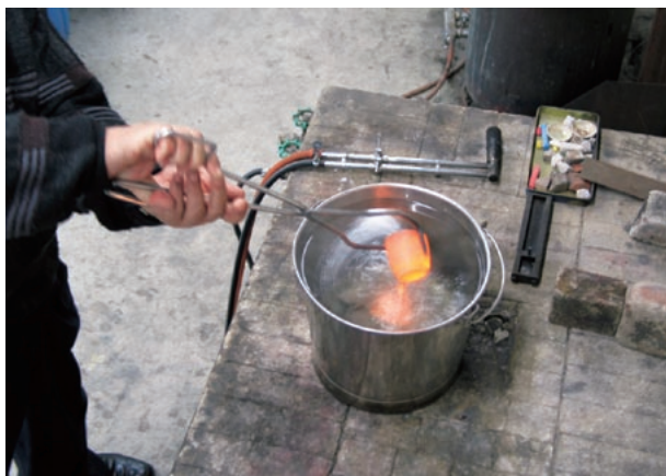
図9 ステンレストングで溶解した金属が入った黒鉛坩堝をつかみ、湯床に流し込んでいる。
