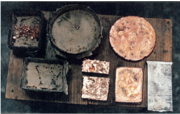
図2 中央より左側にある3つが、形の異なる湯床。中央より右側にある4つは、形の異なる湯床などを用いて制作した地金。このうちの1つは、ガスによって凹みができただため、そのへこみ周辺の観察のために切断したもの。
