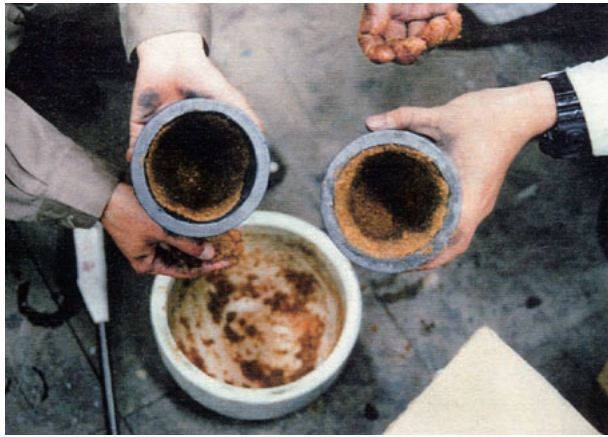
図7 米糠と菜種油を混ぜ合わせたものを、黒鉛坩堝の内側に貼り付けている。
