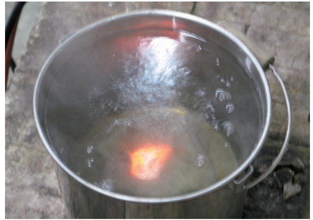
図10 湯に沈んだ湯床の中で、溶解した金属が凝固を始めている。多くのガスが溢れ出ているのが確認できる。
