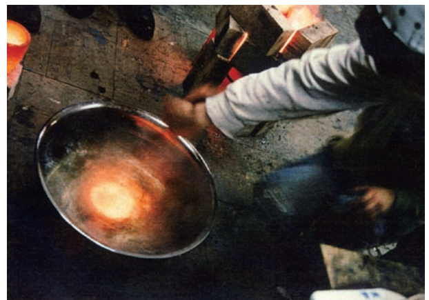
図12 溶解した地金が流し込まれた湯床の周りを、木製の棒でかき混ぜる
