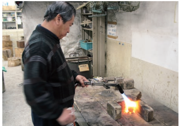
図5 地金が入った黒鉛坩堝を囲むように耐火レンガを並べ、ガスバーナーで黒鉛坩堝を加熱している鳥田稔弘（宗吾）。
