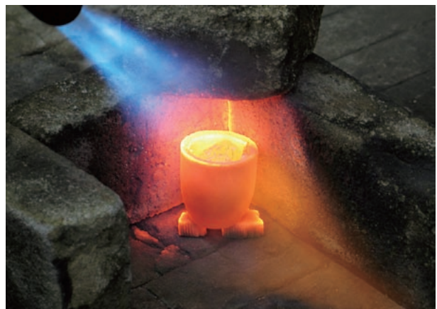
図6 地金が入った黒鉛坩堝を囲むように耐火レンガを並べ、ガスバーナーで加熱をしている。
