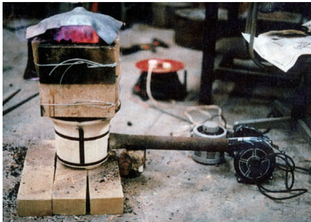
図8 七輪の上に耐火煉瓦を重ね、その中にコークスを入れ、ブローワで風邪を送って、火力を上げている。耐火煉瓦の上に載せてあるものは、銅板で、火力を落とさないための工夫である。この方法を2～3回行った後は、新しい七輪が必要になる。
