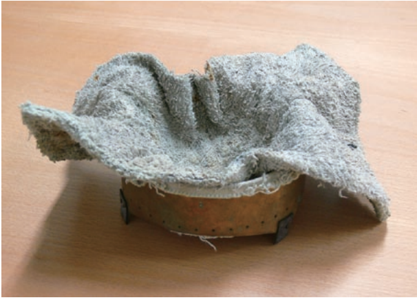
図1 真鍮製の輪に帆布を木綿糸で縫い付けたものに、更に雑巾をのせてある。
