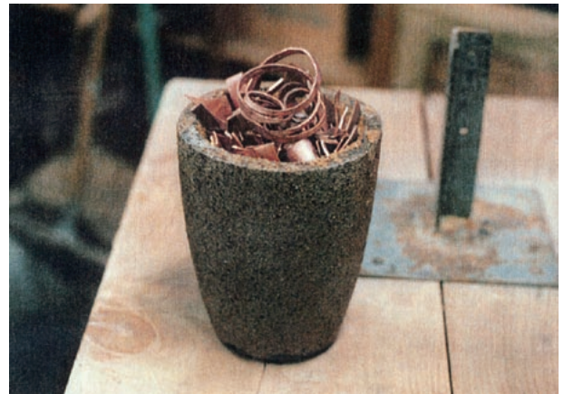
図11 米糠と菜種油を混ぜ合わせたものが、黒鉛坩堝の内側に貼り付けられた後、細かく切断した地金を詰め込む。
