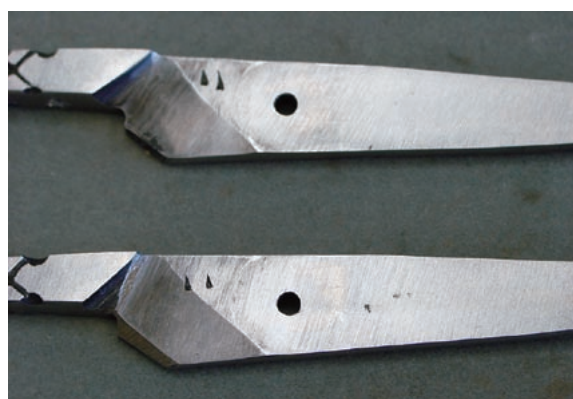
③ 鋏A(6寸)：目釘を中心に刃とミネ側の二点に強く摩擦痕がある。
