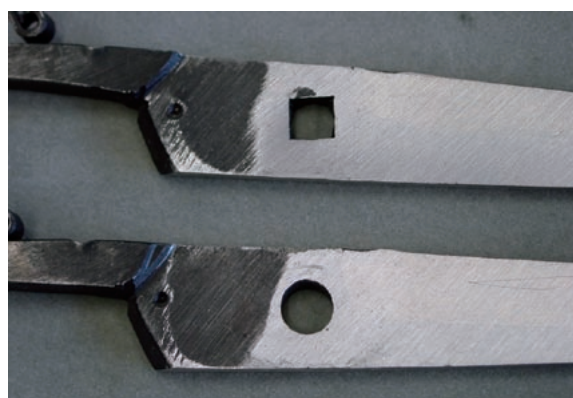
② 種子鋏(8寸)：アゴの近辺に摩擦痕があり、特にミネ側に強い痕が確認できる。
