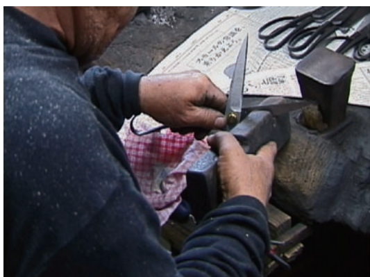
図9-21 カッテ(穂) クネリギによって穂の湾曲を調整し、適度な擦り合わせ抵抗を与える。この操作によって刃の隙間に被切断物の入り込みを防止する。
