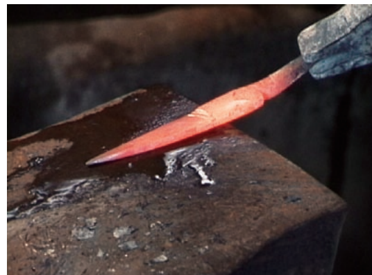
図9-6 アラツクリ(水打ち) 金床に水を散布して打ち、酸化膜を剥離させると同時に後シノギを造る。
