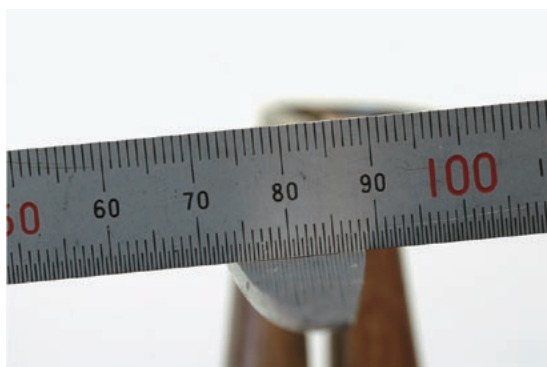
③ 鋏の刃の中央部分（二分の一）：傾斜角6度
