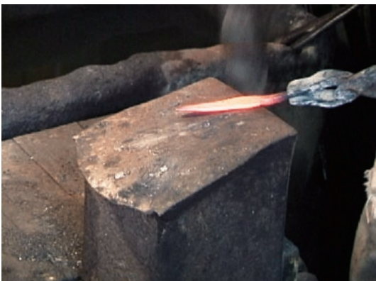
図9-5 アラツクリ(穂の鍛造) 金属を数回にわたり加熱と鍛造を繰り返し、軟化(焼鈍)状態を保ちながら穂の形に成形する。
