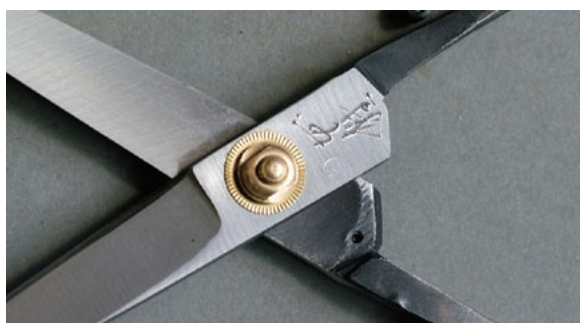
図7 種子鋏(8寸)のスリアワセ面の接点(摩擦痕)
