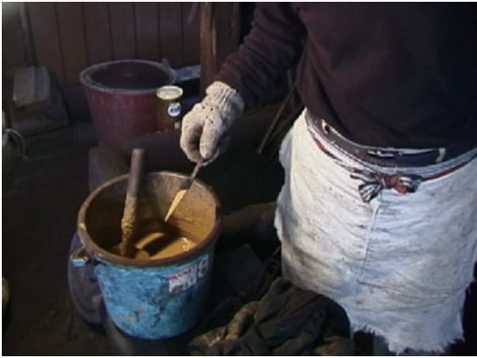
図9-15 焼入れ(焼刃土) 穂の部分を液体状の焼刃土(粘土)に浸し、焼入れの準備をする。
