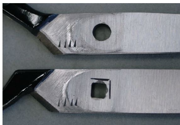
① ラシャ鋏B：スリアワセ面のほぼ中央に楕円状で摩擦痕が確認できる。
