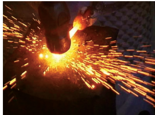
図9-4 ワカシツケ(鍛接) 金槌で圧力を加えて高炭素鋼を接合する。その際、鍛接剤や酸化物などの不純物が火花として飛び散る。
