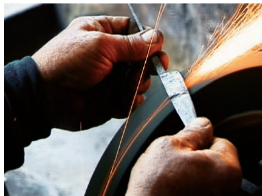
図9-8 スリアワセ面の切削
