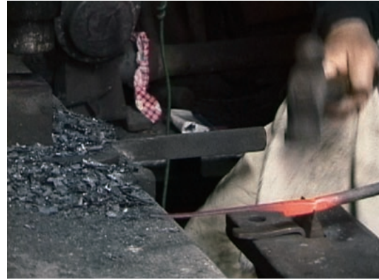
図9-2 タードリ(切断) 一般に地金取りと言われる。鉄一パーツ分の量を決定し、金床に固定した鑿によって切断する。
