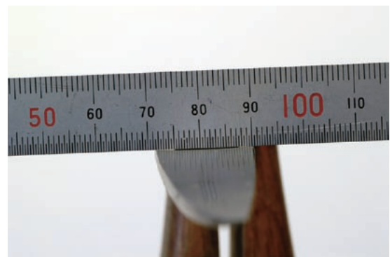
② 鋏の刃がついている元の部分：傾斜角3度
