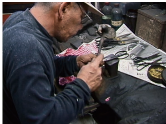
図9-20 カシメ 二つのパーツを目釘(リベット)によってカシメ合わせ、一組の鋏に仕上げる(6寸)。
