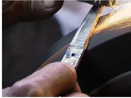
図9-14 ナマト(ウラ) 焼入れ前(生の状態)に穂(ウラ)の切削を行う。この工程では高炭素鋼にダメージを与えないように水で冷やしながら行う。
