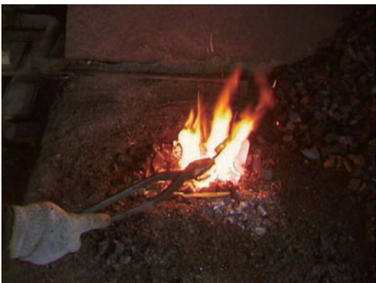
図9-17 焼戻し 焼入れの後、炎にかざして視覚的に加熱温度を見極めて水槽に投入する。
