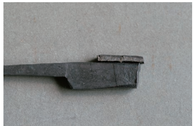
図1 高炭素鋼の設定 地金の先端から1mm多く出す
