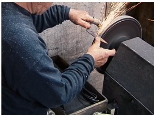
図9-19 アラミガキ 焼入れしたパーツの座の部分に # 240 のベルトペーパーによって仕上げの研磨を行う。
