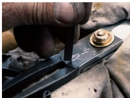
図9-22 銘彫り 先端が扁平で山形になっている鑿によって蹴り彫りを行い、「本種」の銘を彫る。
