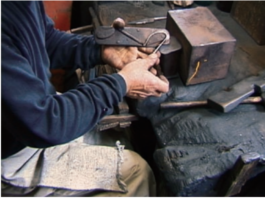
図9-13 ウデマゲ(腕曲げ) ミナヅリを腕曲げ型の先端に引っ掛け、移動しないように設定し、次に腕曲げ型に沿わせて曲げる。
