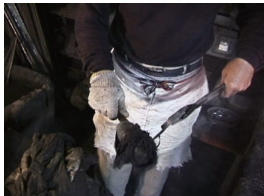
図9-18 サバシ油 腐らせた菜種油・椿油などをしみこませた布によって、加熱した腕に擦り付けて黒く着色する(焼付け)。
