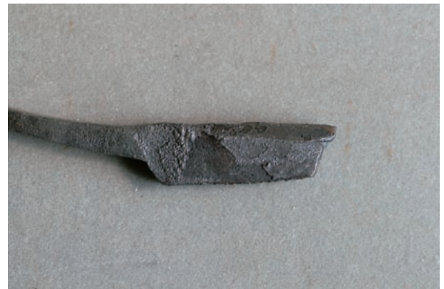
図3 高炭素鋼の角を斜めに打つ(菱形)
