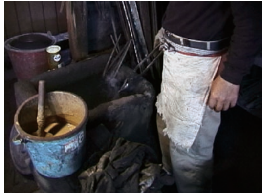
図9-16 焼入れ 火床での加熱温度(柿の熟した色)を視覚的に見極め、直ちに水槽に投入する。
