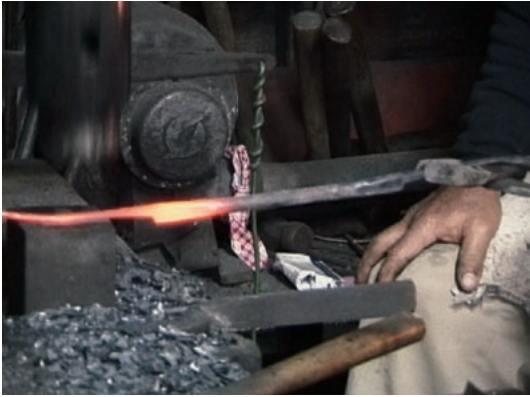
図9-1 タードリ(鍛造) ベルトハンマーによって穂と腕の部分に段差をつけ、おおよその形に鍛造を行う。
