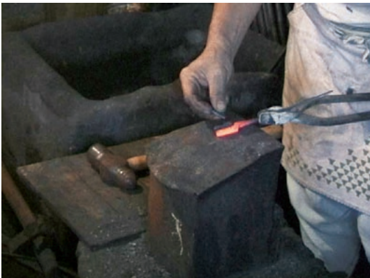
図9-3 ワカシツケ(鋼の設定) タードリした極軟鋼を加熱し、鍛接剤を塗布した後、その刃にあたる部分に高炭素鋼を設定する(杵置き法)。
