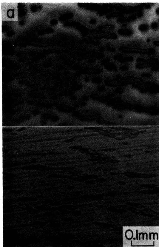
図-3 TGS(010)面の強誘電分域 (a)、2次電子像 (b)、エッチング像
