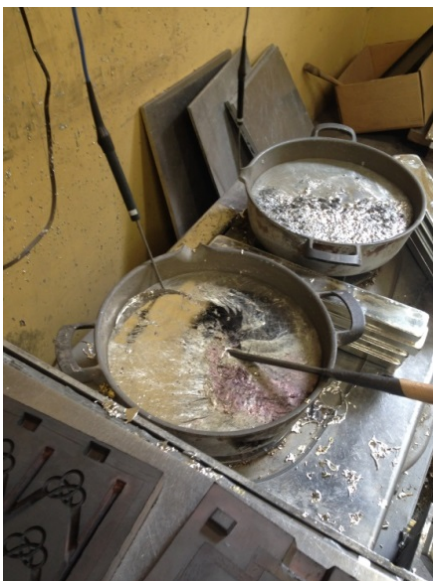
写真 6-7. 家庭用コンロで溶かしたすずと冷えて固まったすず
