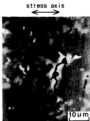
図6 き裂発生点近傍の観察結果(AC8A-T6, \sigma_a=200 MPa)
