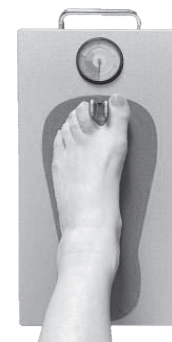
Fig. 1b Toe gap force meter “Checker-kun” (Nissin Sangyo, Co., Japan)
