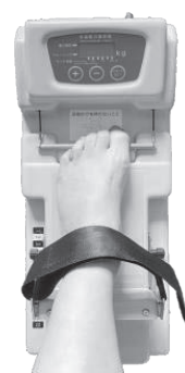
Fig. 1a Toe grip strength meter (Takei, Co., Japan)
