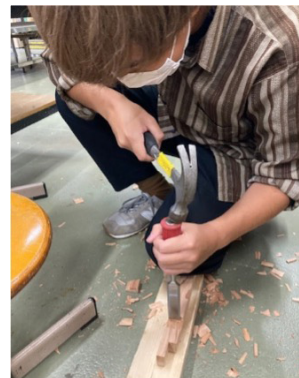
写真5(左) 制作風景。ノミを使ってほぞ穴加工。
