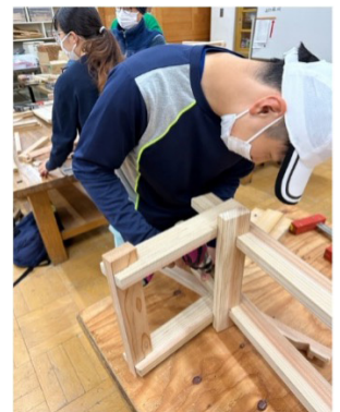
写真5(左) 制作風景。ノミを使ってほぞ穴加工。
