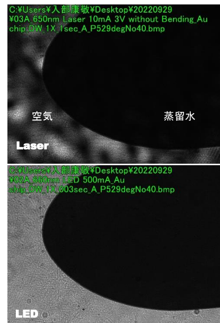
図2 各光源使用時の入射角度 52.9[deg]における SPR 画像
