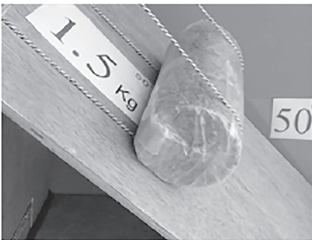
第5図 傾斜角50°での掛け縄運搬の様子
