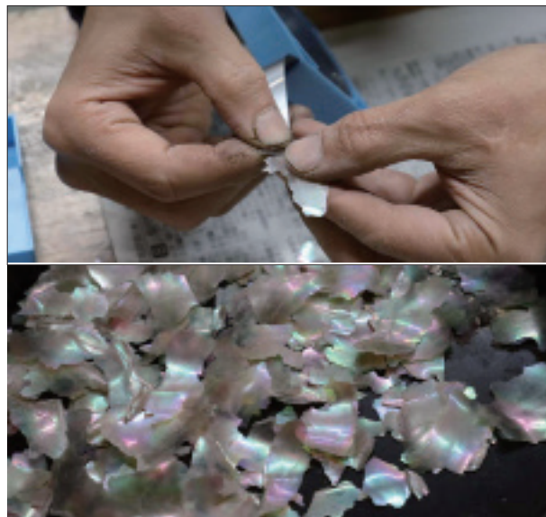
写真11 上：シックネステープを用い貝を更に薄く剥ぐ。 下：概ね 0.1 mm ぐらいの厚みに揃えた薄貝。
