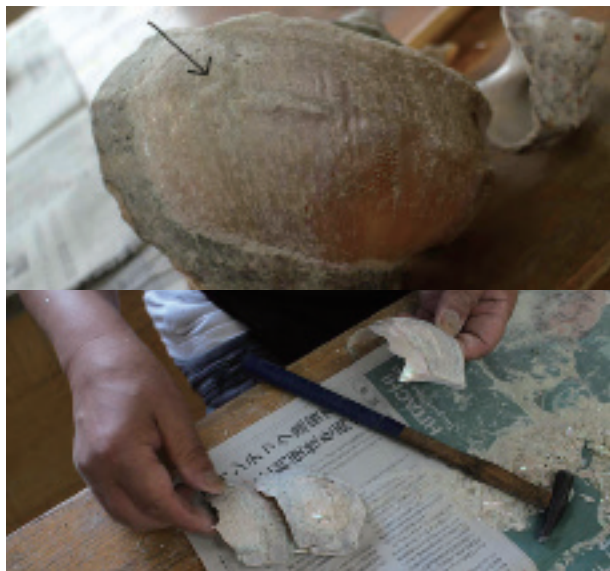
写真7 上：3日目：黒い矢印は叩く方向を示している。 下：早い段階で叩き過ぎると大きなブロックで割れる。
