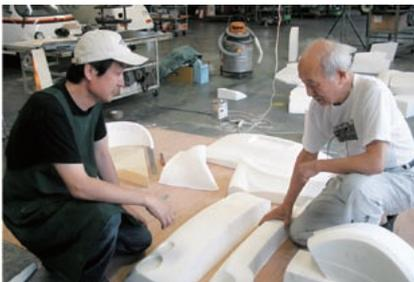
CAD データから削りだしたパーツを組み上げ原寸モデルを制作
