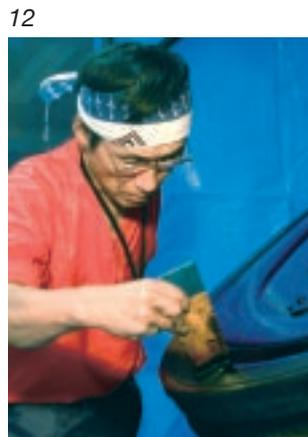
12 上塗りは、制作者の内島氏が担当して行った。裏側の目弾き部分と複雑な作業を要する部分は両氏が協力して行った。「塗り立て」で仕上げるため、上塗りの仕上がりがそのまま車輪の表面になるので、なるべく塵の無い塗面に仕上げる必要がある。部屋を密閉し、埃の立たないナイロン製の衣服を着て作業をする。塗りあげた塗面に塵が落ちている場合は、鳥の羽根の軸を鋭く切った先で塵をすくい上げて取り除く。他の面に漆が付いてしまった部分は、水牛の角筥で残さず取り除く。
