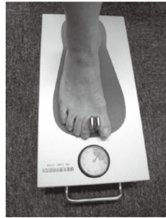
図2 足指力計測器による足趾挟力測定
