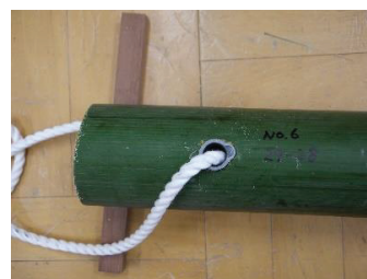
図 22 塩ビパイプ端の変形
