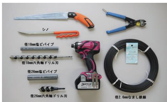
図 9 試験体の製作に用いた材料と工具
