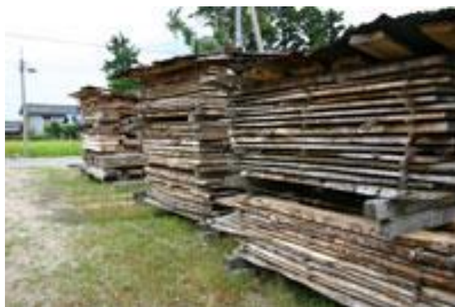
写真 4 板づみの様子
