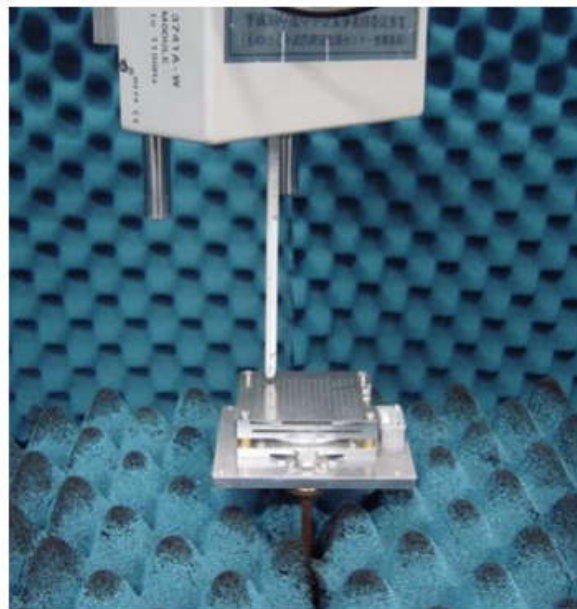
図 6.12 導波管プローブを用いた放射スロット近傍での移相量測定の様子
