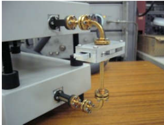
図 6.3 トロンボーン型移相器の測定の様子
