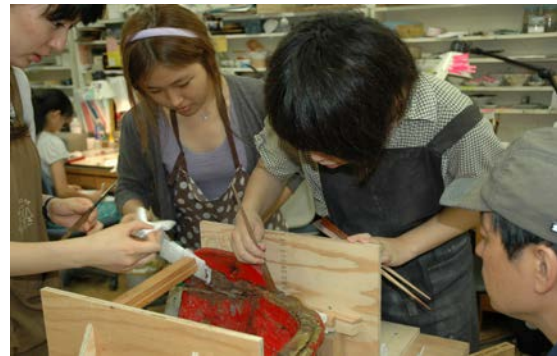
0717-18 上顎と右側面接合部の接着 セメダイン SG-EPO EP007 を接合部の両面に竹べらで塗る。
