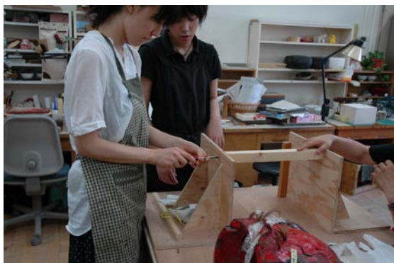
0725-21 治具上部の棒を外す 治具上部の棒に引っかかって、頭が入らな かったため、プラスドライバーでネジを外 し、棒を外す。
