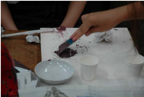
0803-33 充填剤を作る マイクロバルーン入りエポキシ樹脂を作る。マイクロバルーンの量を増やし、少し固めに作る。
