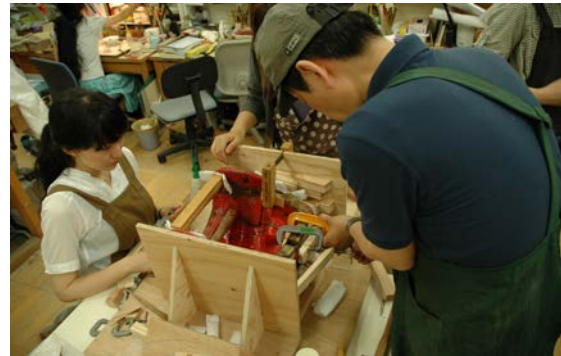
0713-26 上顎右側のラインの整形 鼻に楔を打って上顎のラインを揃え、3か所をクランプで締めて整形する。
