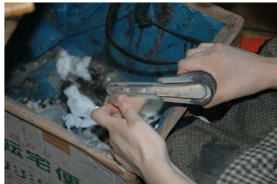
0803-10 ベルトサンダーで削る ベルトサンダーで木材を削り、カーブ部分 を調整する。確認と削りの作業を何度か行 い、カーブを合わせた。
