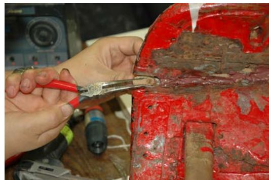
0720-08 ラジオペンチで歪んだ部分を切断する。
