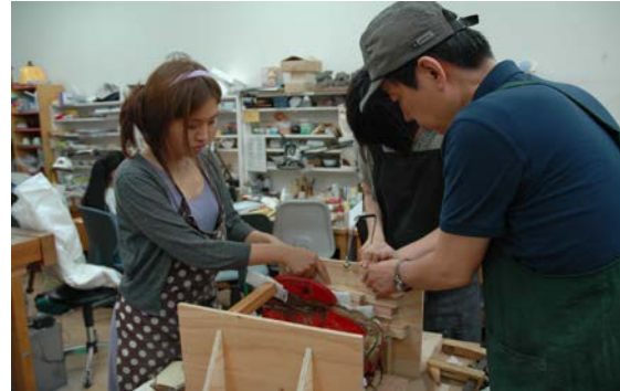
0713-20 背板の一部の切り取り 接着部分を木製クランプで固定するため 背板の一部を金鋸で切り取る。
