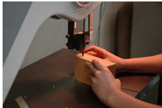
0820-16 右耳を切り出す 卓上帯鋸盤を使用して右耳を切り出す。
