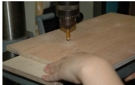
0709-07 皿もみ加工 木ねじの頭が出ないように加工する。
