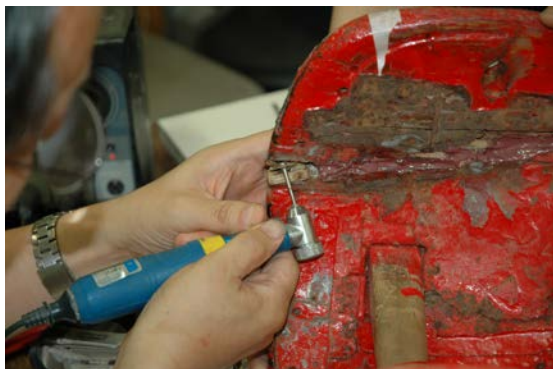
0720-07 釘をダイヤモンドカッターで切り落とす。
