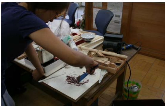
0730-27 充填材を作る (エポキシ樹脂 + マイクロバルーン)
