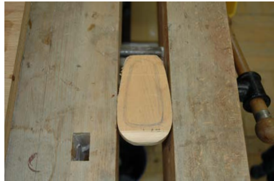
0820-20 右耳内側を削りぬく 右耳内側を削りぬくために万力で固定する。
