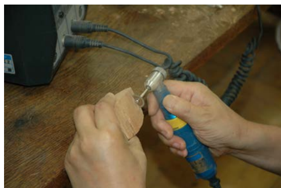
0802-34 充填木材の鼻の穴の作成 ダイヤモンドカッターで鼻の穴になる部分を削る。削り取った部分はラジオペンチで取り除く。
