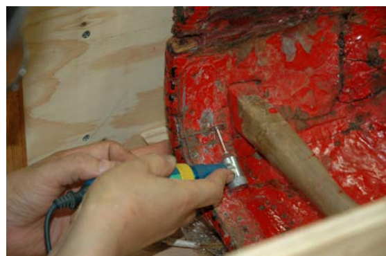
0725-42 鉄板を切断する ダイヤモンドカッターで鉄板を切断する。 切断によって 1mm ほどの隙間ができ、右 側面のカーブを調整する余裕が生まれる。
