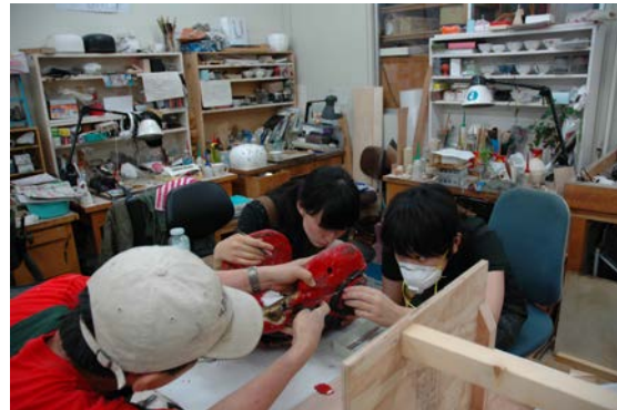
0719-10 外側の接合面を合わせ、右頬を 内外と動かしながらひっかかりのある部 分を探し、引っかかりを削る。この作業を 何度も繰り返した。
