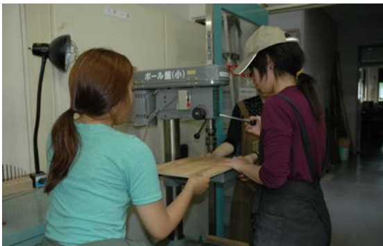
0709-06 木ねじで留める部分の穴あけ ボール盤で穴をあける。
