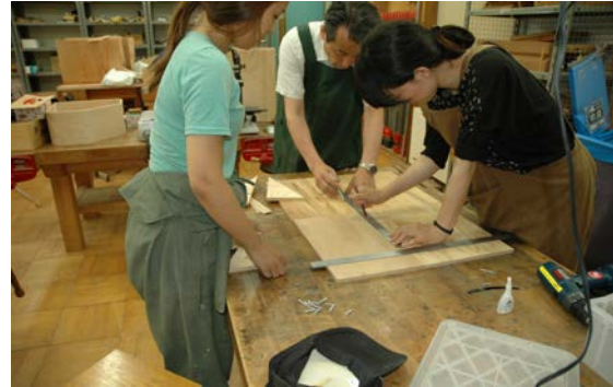
0709-05 木ねじで留める位置を決める 背板3箇所、底板2箇所を木ねじで留めることとし、位置を決める。
