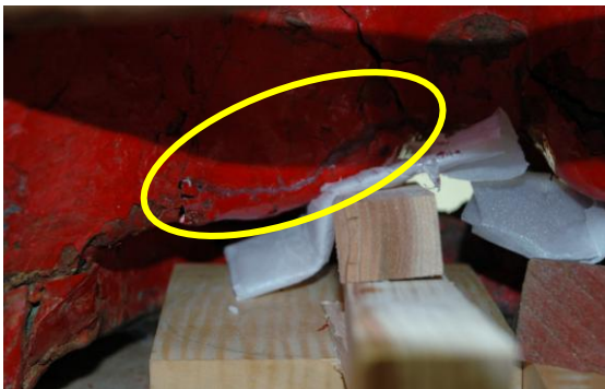
021 左目下マイクロバルーン入りエポキシ樹脂充填後（裏） 左目下の隙間が埋まっている。
