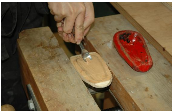
071 卓上帯鋸盤とベルトサンダーで切り出した後、小刀で外形を削り出し、丸ノミで内側を削りぬく。
