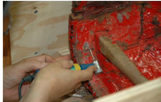
044 頭後部端の鉄板を切断 鉄板は二重になっており、下の鉄板が二か所 割れている。右側の割れ目をダイヤモンドカ ッター切断する。
