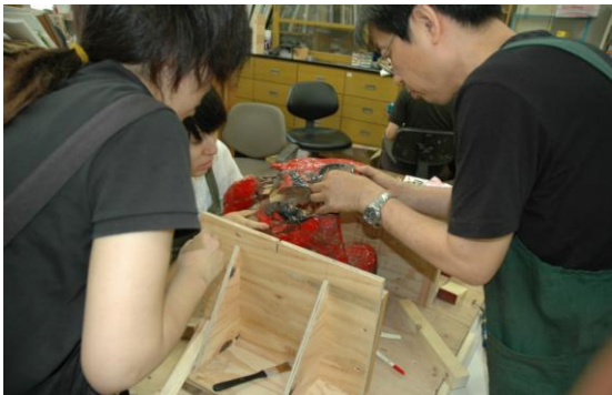
045 右側面の取り外し 取っ手が釘で留まっているため、釘を抜い て、右側面を取り外す。
