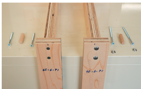
図19 L型仕口試験体の形状と試験方法
