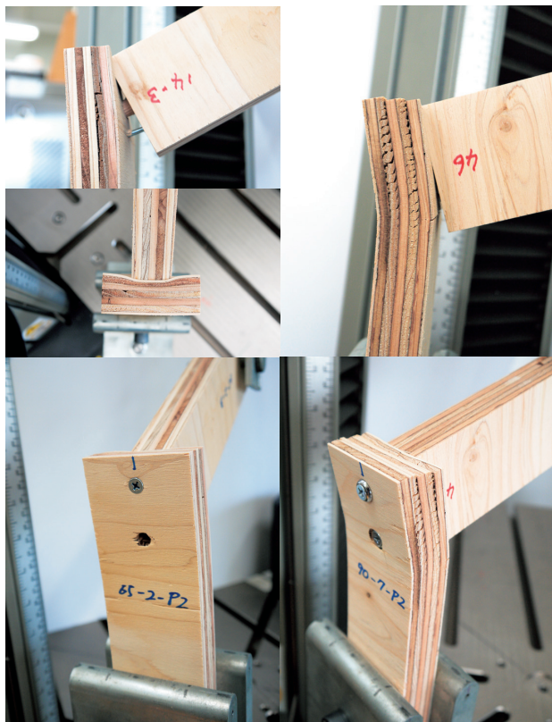
図21 引張加力によるCTS65仕口(左)と山形座金2付きCTS90仕口(右)の代表的な破壊形態
