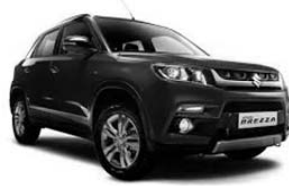
VITARA BREZZA 1248cc エスクードをベースにインド市場用に開発。 現地の税制に配慮し、エスクードよりも小型化。(全長4,000mm以内に)
