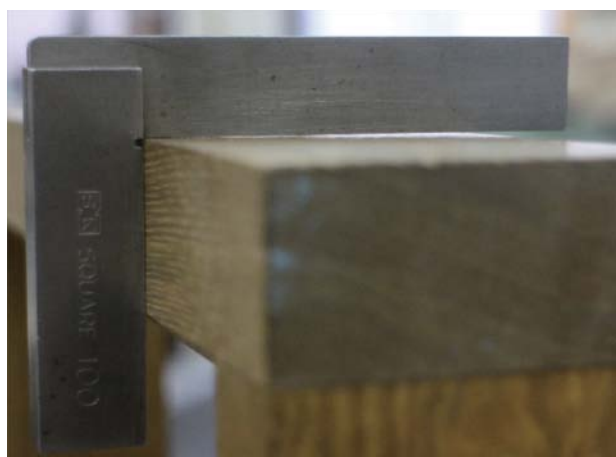
図5 底面に向かい大きくなる直角定規（スコヤ）と材の隙間
