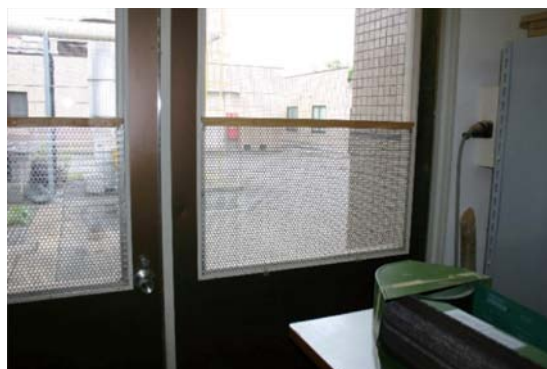
写真13 ベルとサンダー使用時に飛散する被加工材からガラスを守るためのプロテクター
