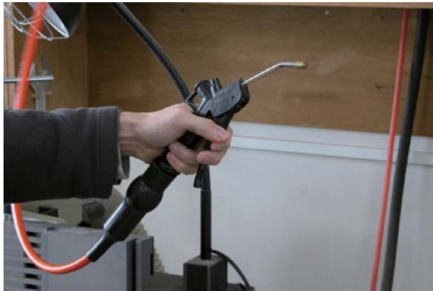
写真22 どの加工機械にも届くように4箇所を設置したエアガン
