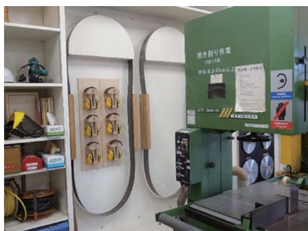
写真29 重ねて置かれていた大型帯鋸の替え刃を、取り出しやすく掛けるために作り変えたパネル
