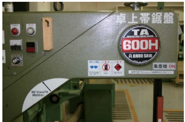
写真8 頻繁に使用する六角レンチを取り付けた卓上帯鋸盤
