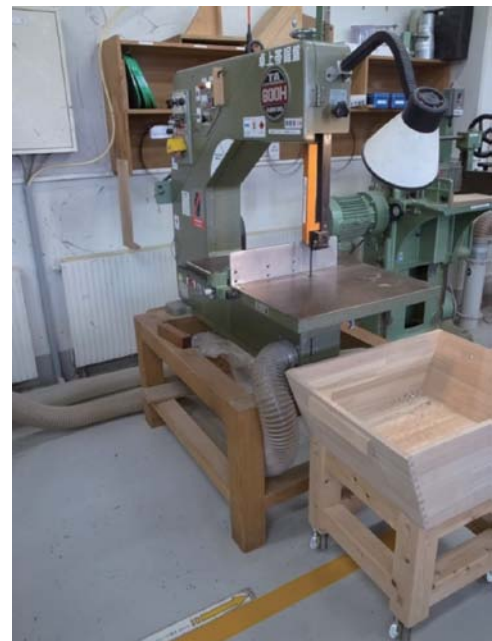
写真25 替え刃、照明、ゴミ箱、集塵の整った卓上帯鋸盤の周辺
