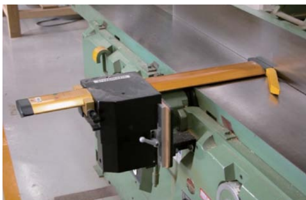
写真10 手押し鉋盤に逃れて取り付けられた外国製の安全装置
