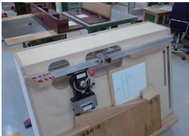
写真9 昇降盤で任意の角度で切る場合に使うジグと専用棚
