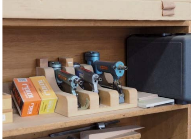
写真6 スペアの刃と共に見えるように置かれたエアタッカー
