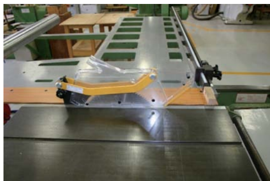
写真15 昇降盤に逃れて取り付けられた安全カバー
