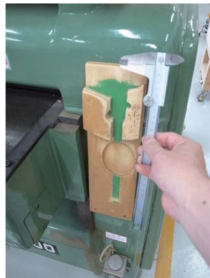
写真20 戻す場所を示すノギスのシルエット
