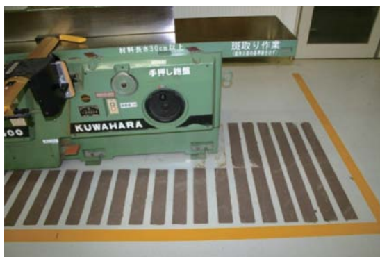
写真14 加工機械の足元に張った滑り止め
