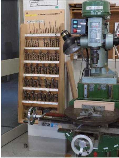
写真3 使用者側に角度を持たせて収納したボーリングマシンの替え刃
