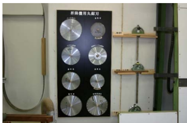
写真27 平成28年に選びやすさ、返却のしやすさを考慮して作り変えた昇降盤の替え刃収納パネル
