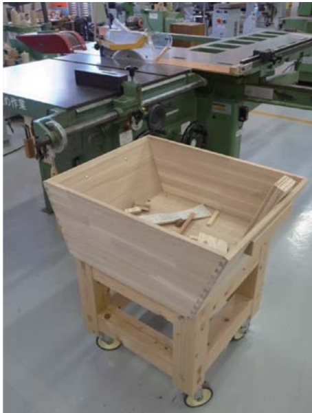
写真21 昇降盤で出た木片をその場で投げ込む移動式のゴミ箱
