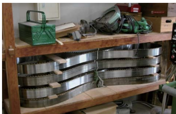
写真28 改善初期に整理した大型帯鋸の替え刃
