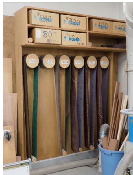
写真2 ベルトサンダーの異なる粒度ごとに表示したベルト掛け
