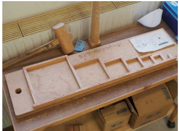
写真7 旋盤に部材をセットする際にセンターの印をつけるジグ
