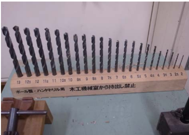
写真5 選びやすく表示した小型ボーリングマシンの替え刃
