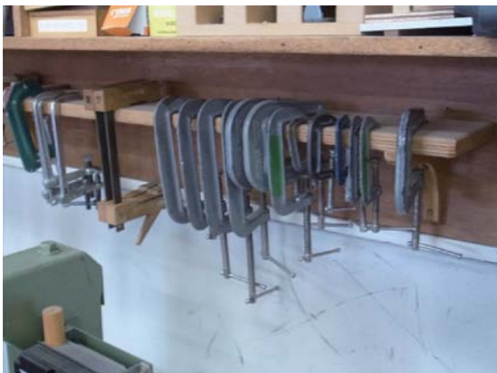
写真17 クランプを戻すための専用棚
