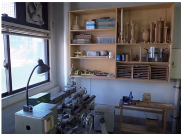
写真23 替え刃、工具、集塵、換気扇、照明が整った旋盤作業の周辺
