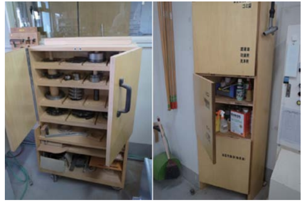
写真30 ルーターマシンの替え刃を収納する専用棚（左）と各加工機械のオイル収納棚（右）
