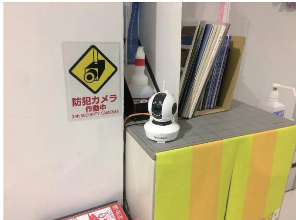
図 6. ネットワークカメラを設置した様子 (耐震ゲルで滑り止め)
