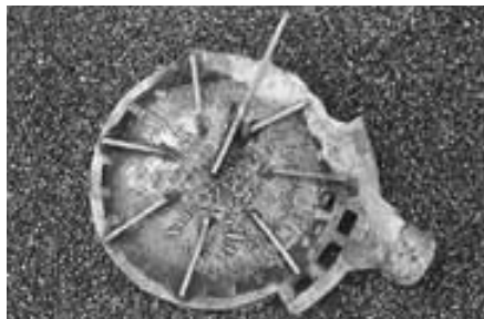
喜多7. 厚さが極めて薄い大皿を铸造した直後。湯道、堰、釣りは多く付ける
