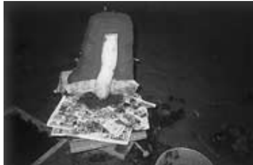
坂田 2. 半面の鑄型が完成し、蠟原型に砥の粉を塗って、もう一つの鑄型を作り始める
