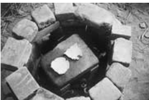
喜多3. 味噌 米ぬかと硫黄を薄く付け、レンガの上に置き、炭火で焼く。この方法では、銀白色に変化するものの、ワイヤーブラシで磨いて容易に除去できない酸化膜が発生する
