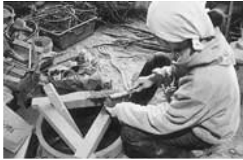
喜多6. ワイヤブラシに砂をつけて磨き、酸化膜を取る
