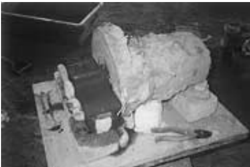
坂田 3. 2つの鑄型が完成したら、幅置部分の押し台を作る
