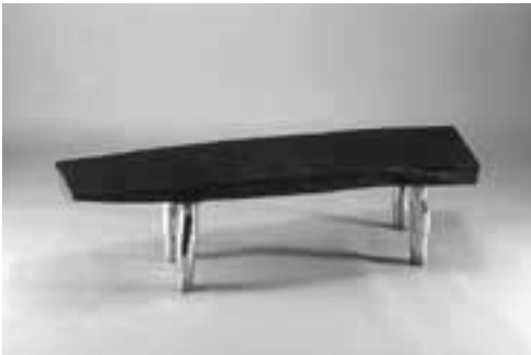
写真3.「卒業制作品」坂田有梨 込型鑄造と蠟型鑄造を組み合わせて制作した無鉛高錫青銅の座卓の脚を、研磨仕上げした作品
