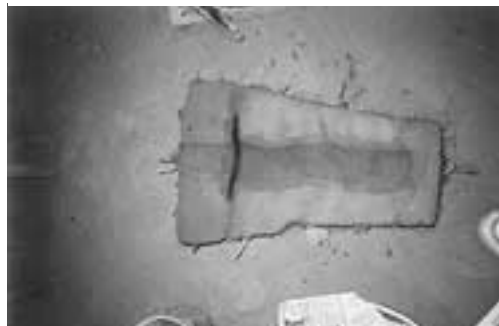
坂田 4. 蠟を溶かしてできあがった脚の外型
