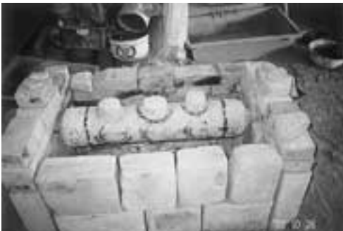
口池1. 鉄棒に縄を巻き、鑄物土を付けて中型「中子」を作り、炭火で乾燥する
