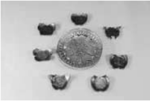
写真1.「卒業制作品」喜多章江 蠟型鑄造で制作した無鉛高錫青銅の皿を、熱処理(味噌焼き)して銀白色に変化させた作品
