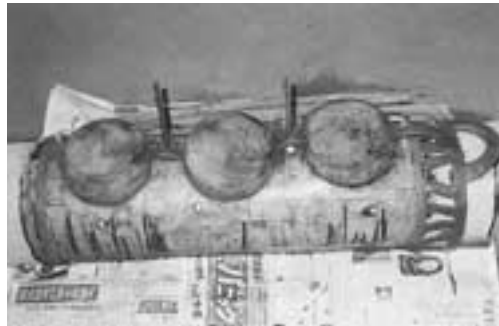
口池4. 完成した蠟原型に湯道、堰、釣りを付ける
