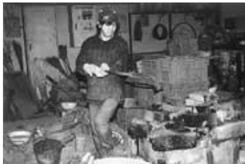
吉行 6. いろいろな条件の時に、ハサミで挟んで塩水に入れ、2回目の焼き入れをして、実験を重ねる
