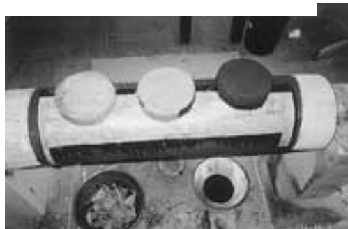
口池2. 中子表面に炭粉を塗り、蜜蝋の板を貼り付けていく
