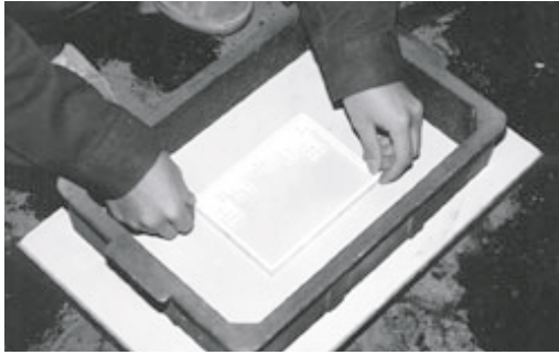
鑄型枠の中にセットした紙原型
