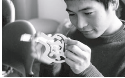
鑄型から抜き取りやすいように紙原型を削る学生
