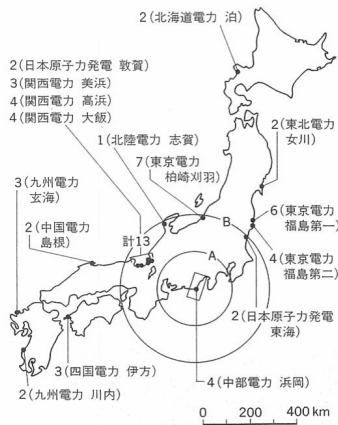
図1 日本の原子力発電所の分布。数字は運転中の原子炉の数。浜岡原発を囲む矩形は東海地震の予想震断断面の地表投影 (2) 。円は、浜岡3号炉が炉心溶融をおこしたときの風下側の長期避難領域を示す (1)(3) (Aはチェルノブイリ事故の際に旧ソ連が設定した基準、Bは白ロシア共和国が設定した基準による)。
